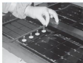
Proyecto paneles solares Fabricación de paneles solares para satélites Centro Atómico Constituyentes Pcia. de Buenos Aires
