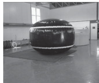
Proyecto Internacional Pierre Auger Vista de un “liner” inflado
