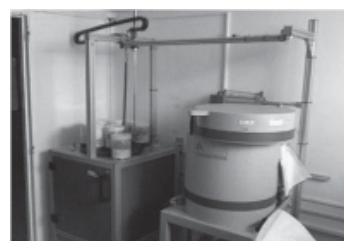
Laboratorio de Metrología de Radiosíotopos Detector de germanio hiperpuro Centro Atómico Ezeiza Pcia. de Buenos Aires
