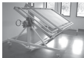
Proyecto Paneles solares Soporte giratorio para la integración de módulos Centro Atómico Constituyentes Pcia de Buenos Aires
