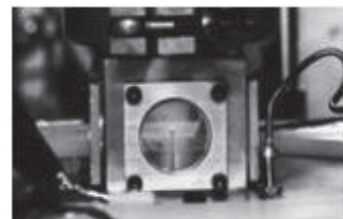
Proyecto PLADEMA - Plasma Focus miniaturizado de 1 J desarrollado conjuntamente con la Comisión Chilena de Energía Nuclear
