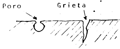
a) Superficie limpia, con fallas
