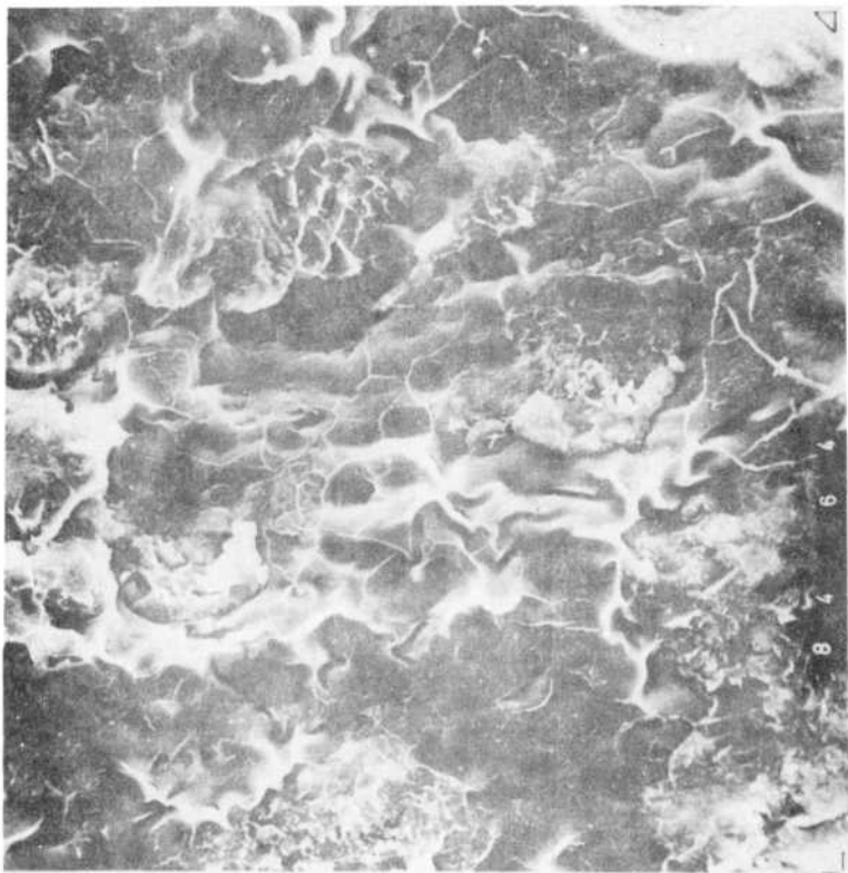
Fig.11: Réplicas preparadas con barniz de nitrocelulosa a partir de superficies de fractura y obtenidas en el microscopio electrónico de barrido.
