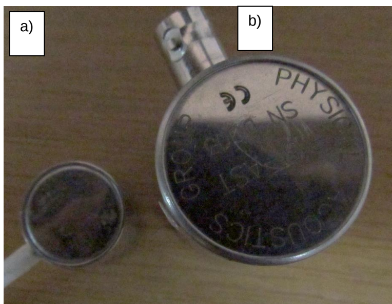
Figura 4.11. Sensores piezoeléctricos a) de banda ancha y b) resonante con preamplificador incorporado.
