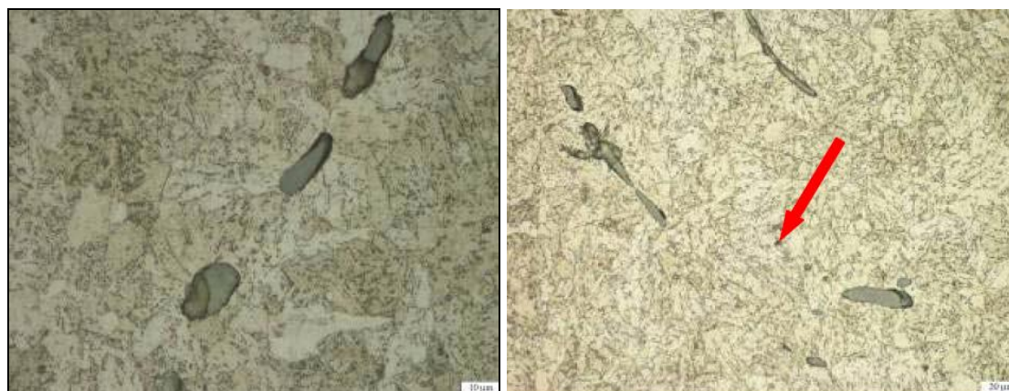
Figura 5.12. a) Inclusiones alineadas b) Inclusiones curvilíneas
