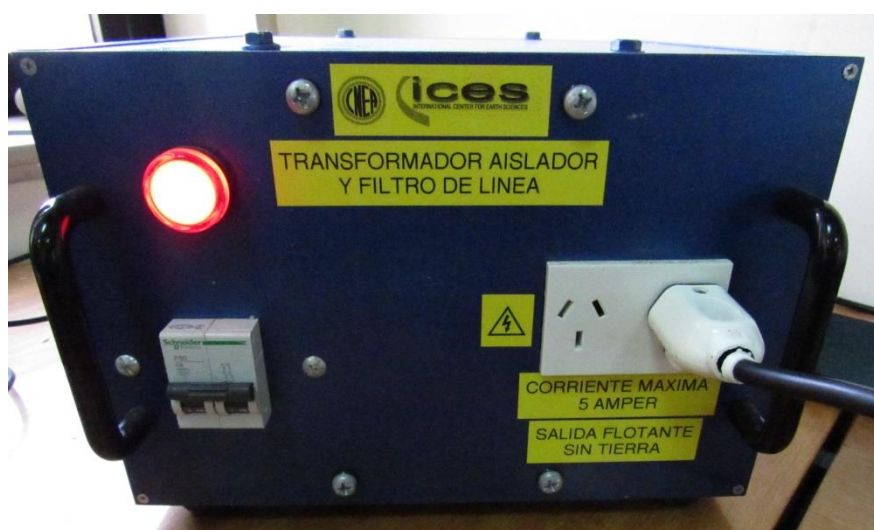
Figura 4.17. Fotografía del transformador aislador y filtro de línea
