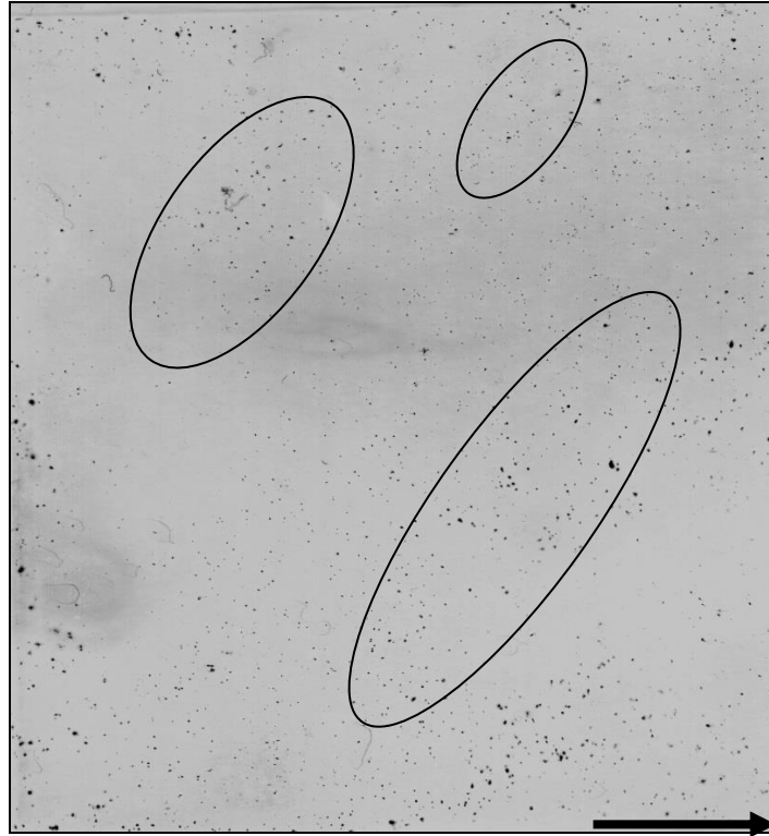
Figura 5.5. Macrosegregación de sulfuros; las elipses indican la dirección de las mayores concentraciones; la flecha negra muestra la dirección de forjado.
