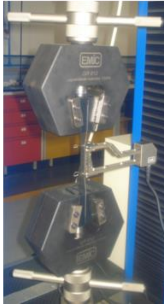
Figura 6.16. Fotografía de la máquina de tracción EMIC con su extensómetro.
