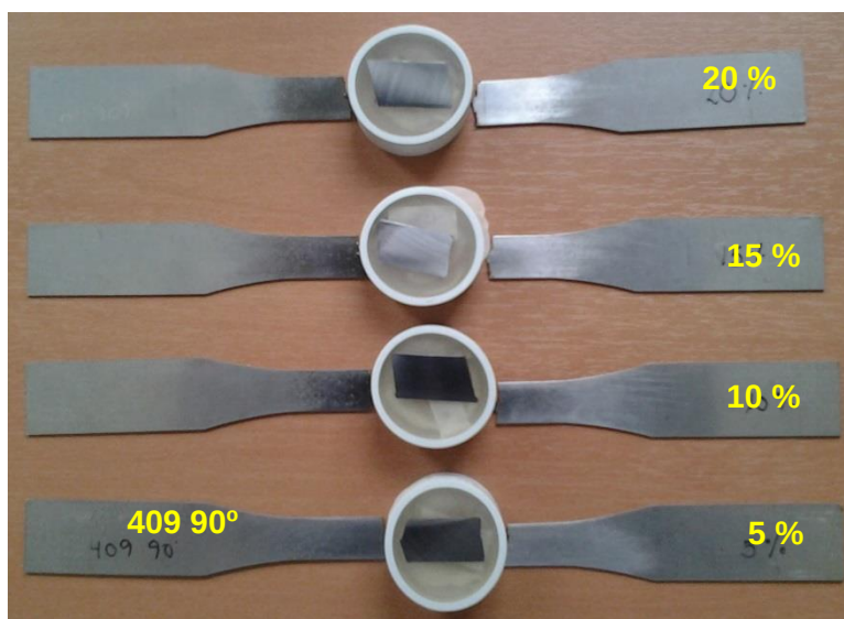
Figura 6.33. Fotografía de las probetas deformadas ( 90^\circ ).
