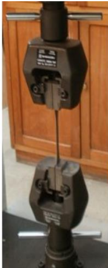
Figura 6.9. Fotografía de la máquina usada para los ensayos de tracción a ruptura, Shimadzu de 100 kN.
