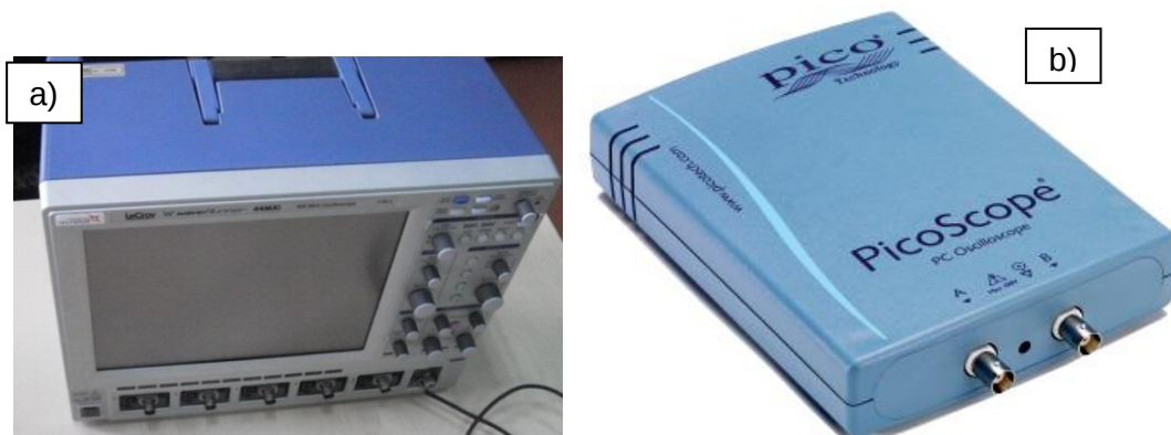
Figura 4.16. Fotografía de los osciloscopios: a) LeCroy WaveRunner y b) PicoScope 4227.
