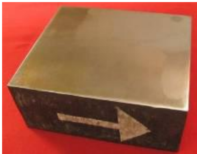
Figura 5.2. Fotografía del bloque estudiado indicando el sentido de conformado.
