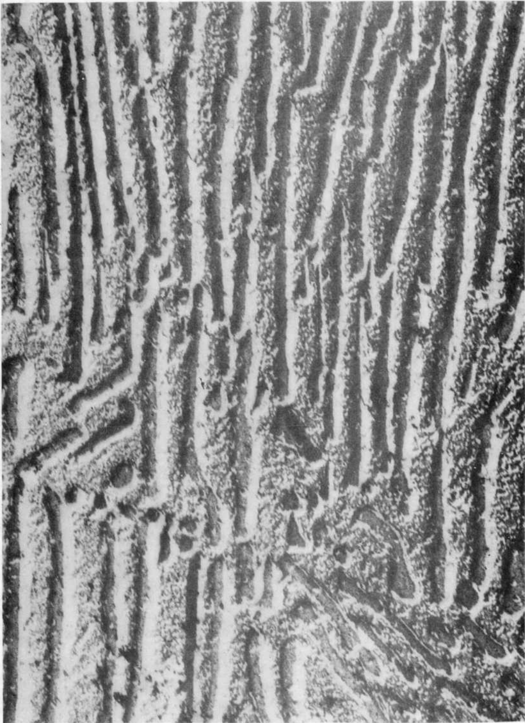
Fig. III.6. Réplica de una muestra de acero laminado, sombreada con oro bajo un ángulo de 45^{\circ} . Foto: T. García de Castillo.
