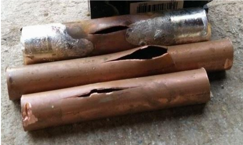
Figura 6: Tubos que han fallado por estallido. Adaptado de [13].
