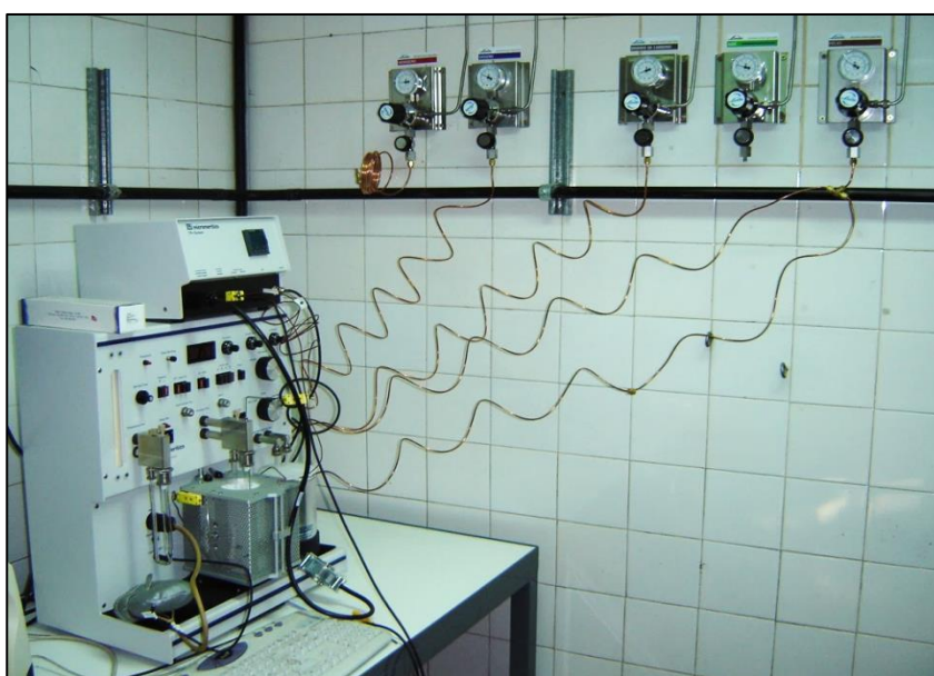
Figura 2.10: Equipo de quimisorción y técnicas de temperatura programada Micromeritics, modelo Chemisorb 2720.
