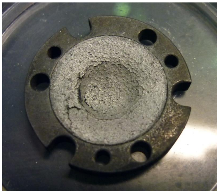
Figura 6.18: Fotografía de una pastilla que contiene NiSDC 900 luego del experimento de absorción de rayos X en atmosfera de oxidación total de metano.
