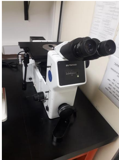
Figura 33: Fotografía del microscopio óptico usado para el análisis de la microestructura
