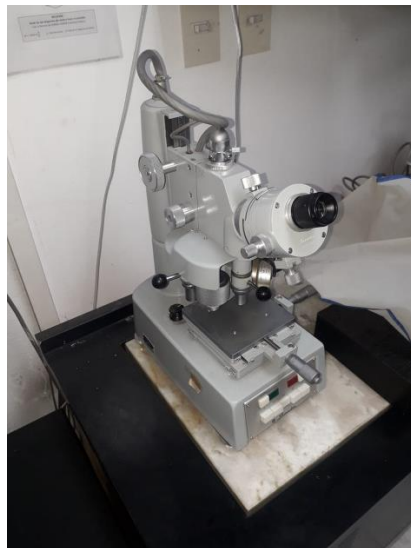
Figura 31: Fotografía del microdurómetro Vickers marca Shimadzu.
