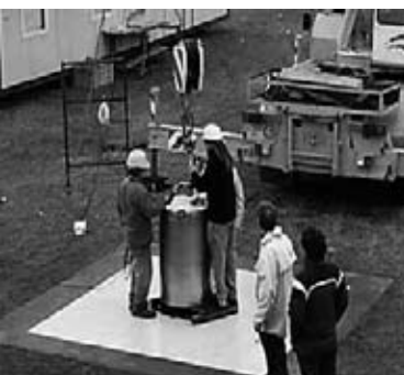
Contenedor DALMA 25 para transporte de soluciones acuosas de uranio enriquecido
