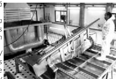
Chimenea para el reactor de investigación y producción OPAL exportado a Australia por INVAP S.E.
