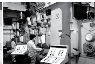
Planta de Fabricación de Generadores de Molibdeno-99/Tecnecio-99 Celdas blindadas con teleanipuladores Centro Atómico Ezeiza
