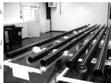
Gestión y extensión de vida de las centrales nucleares para la Central Nuclear Embalse Tubos de presión terminados para ensayos de certificación
