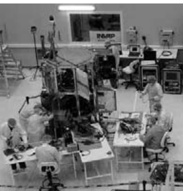
Sala limpia de INVAP S.E. para integración de satélites
