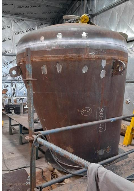
Figura 32: Troncocónica VM-4006 con cabezal soldado para la prueba hidráulica, pendiente de la finalización de los ensayos no destructivos (END).
