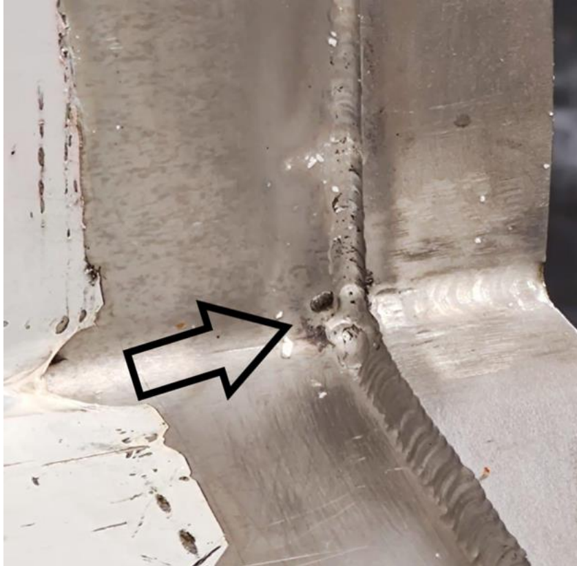
Figura 37: Partículas superficiales detectadas en el cordón de soldadura.
