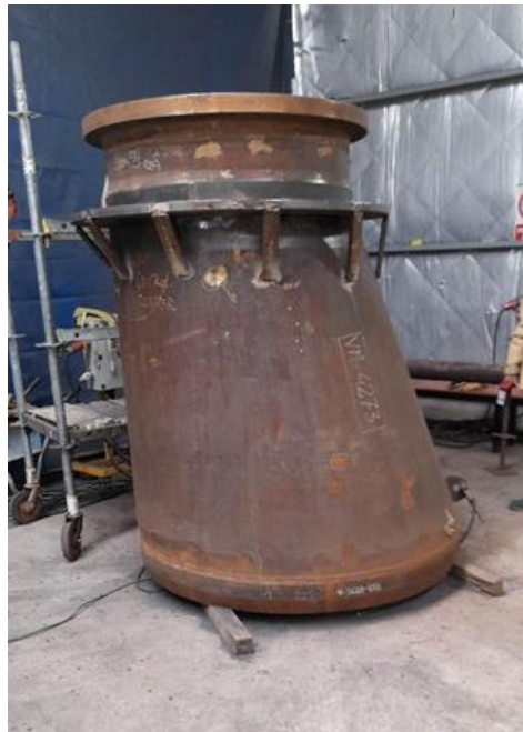
Figura 33: Troncocónica VM-4273 en proceso de soldadura de soportes provisionales.
