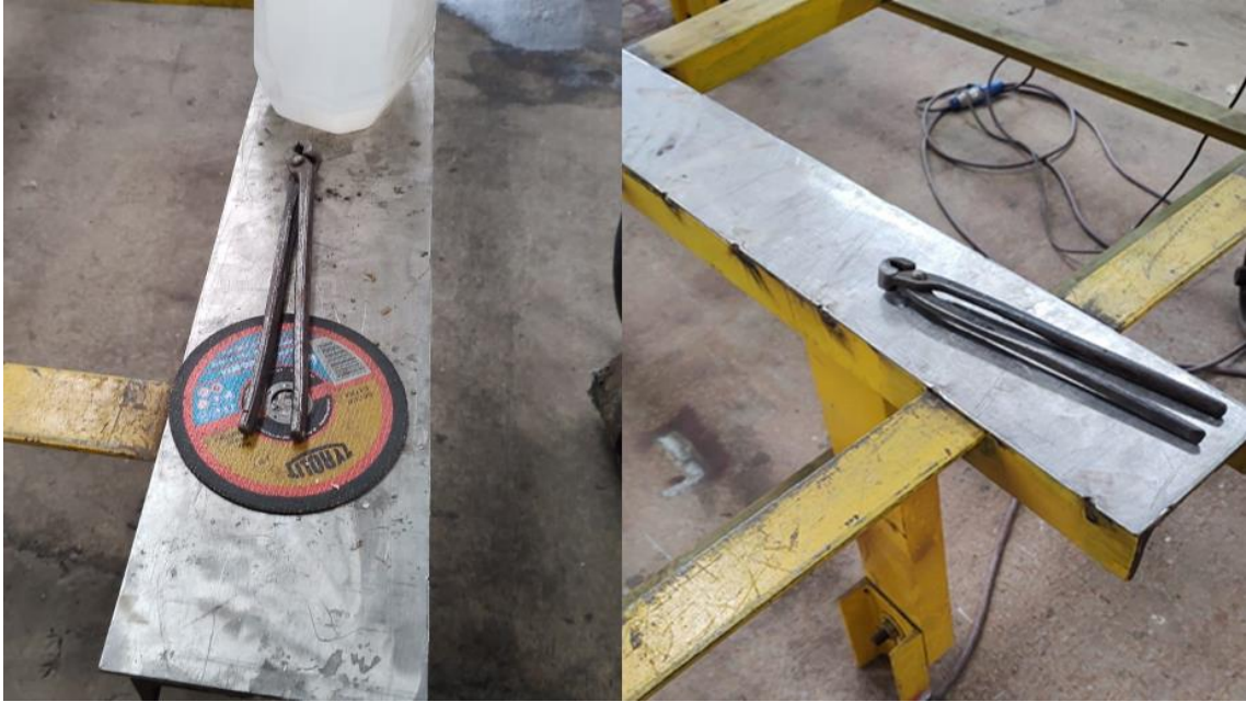
Figura 38: Herramental de acero al carbono en contacto con placas de acero inoxidable.
