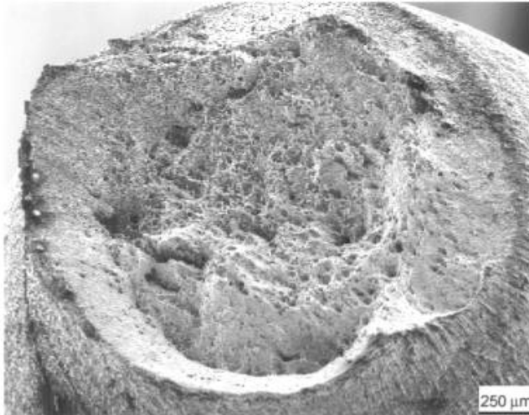
Fig.22 Probeta con Oxido de titanio ensayada al aire.
