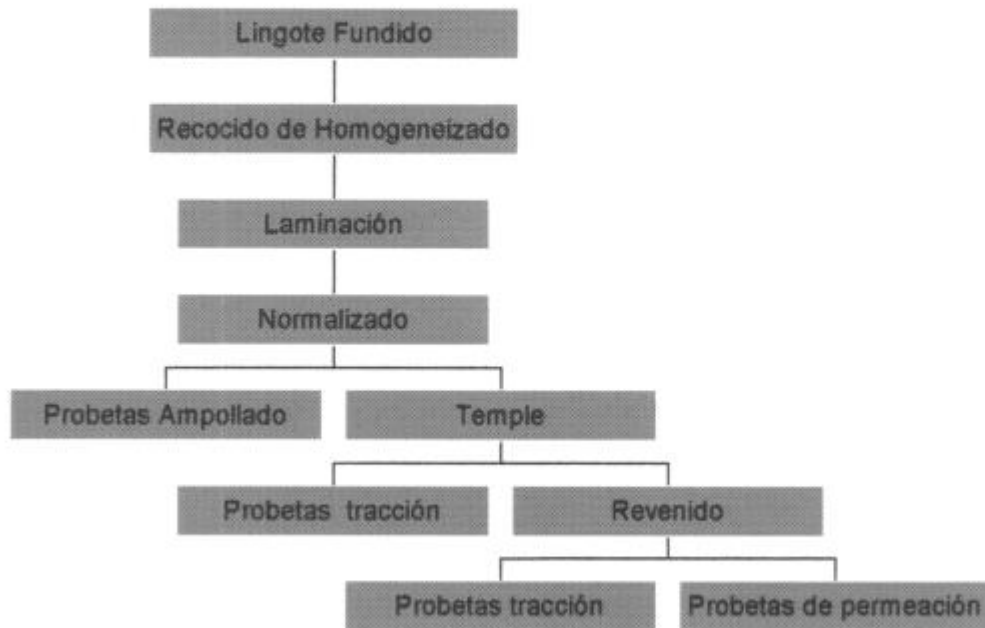
Fig. 3.2. Diagrama de flujo del proceso
