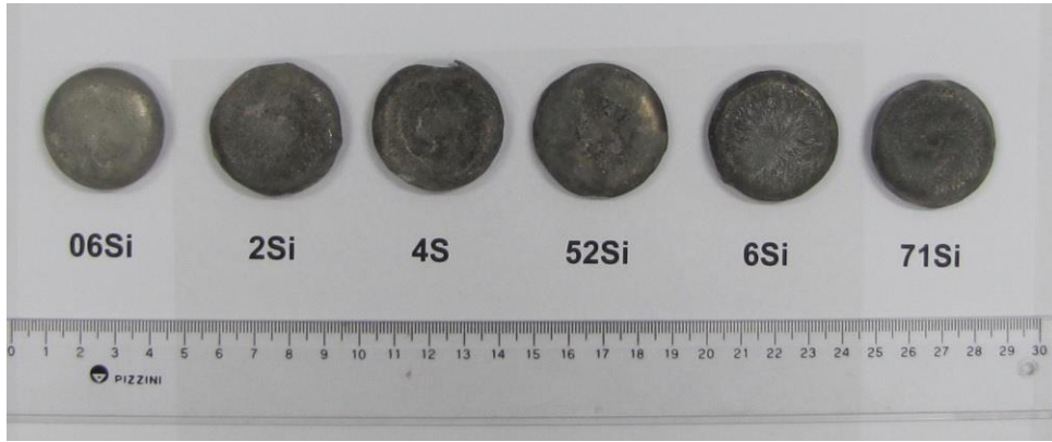
Figura 4: botones de Al(Si) luego del proceso de fabricación en el horno de arco.
