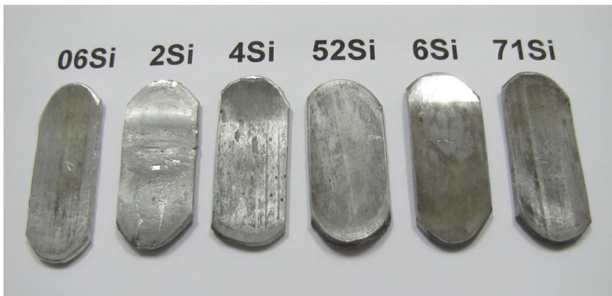
Figura 5: láminas de Al(Si) luego del proceso de laminación, láminas plano paralelas de 3.8mm de espesor.
