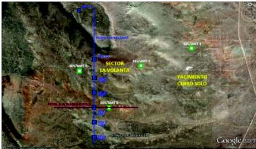
Figura 6. Ubicación de los sondeos SEV/AMT del perfil N-S y del perfil dipolo-dipolo E-O en el sector de estudio, Yacimiento Cerro Solo (Imagen de Google Earth)
