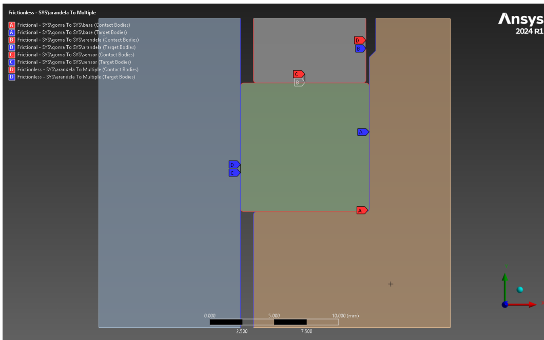
Figura 5.17 Configuración de contactos. A, B y C contactos friccional entre elastómero y demás piezas. D contacto frictionless entre arandela, varilla y soporte de sello.
