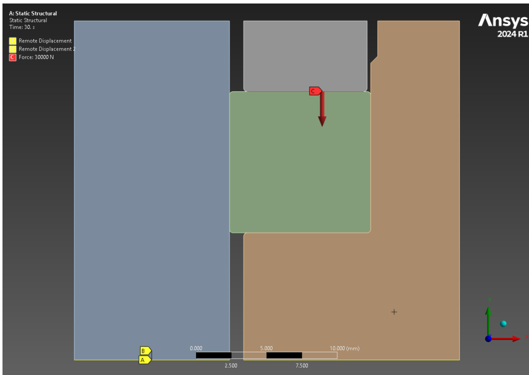
Figura 5.14 Modelo de sellado. Se observan las cargas de la primera etapa, sellado en frío a 23°C. A y B son las restricciones y C la fuerza de 30 kN aplicada en la cara inferior de la arandela de compresión.
