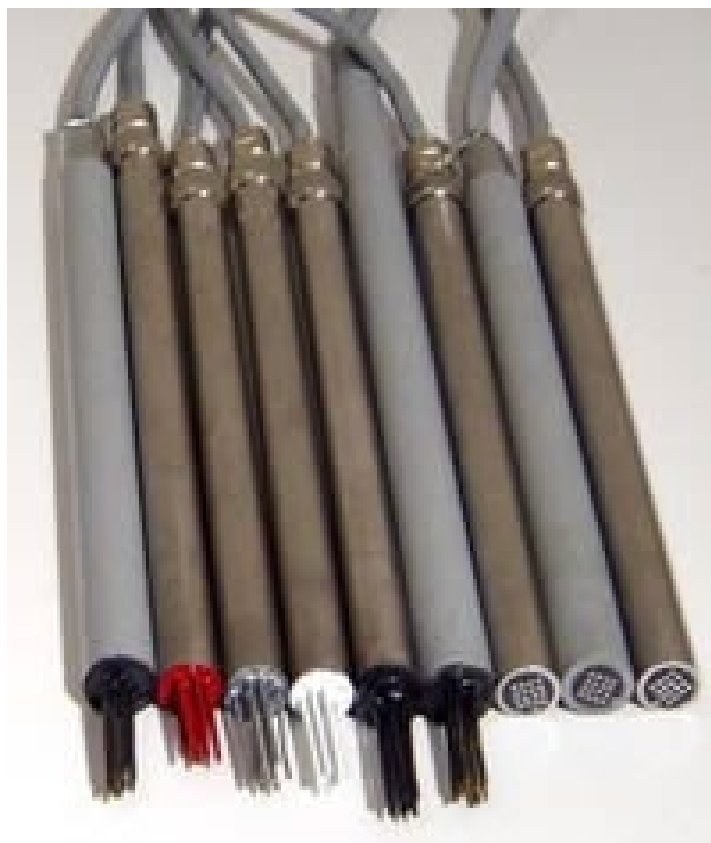
Figura 2.18 Sondas de múltiples elementos. Tipo finger, izquierda. Tipo flush, derecha. Modificado de [16].
