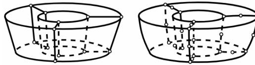
Figura 3.5 Elementos de sólidos axisimétricos. De 4 a 48 nodos (izq.) Y de 8 a 96 nodos (der.). Modificado de [22].
