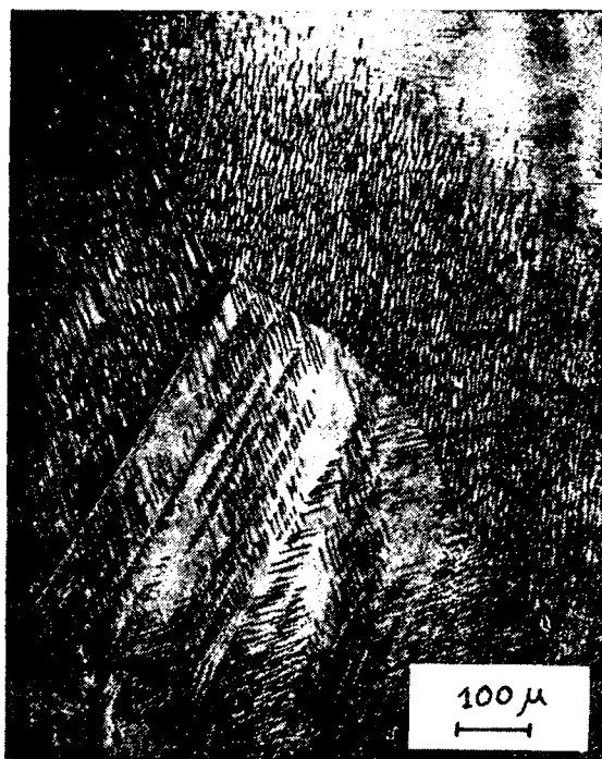
Fig. 3 Microscopía de probeta laminada 5% a temperatura ambiente.
