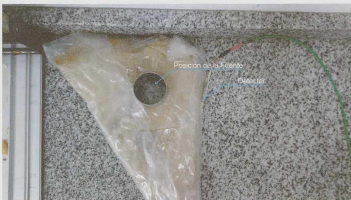
Figura 4.4: Bloque de parafina utilizado para moderar los neutrones provenientes de la fuente de ^{241}\text{AmBe} en los experimentos mencionados en este Capítulo.
