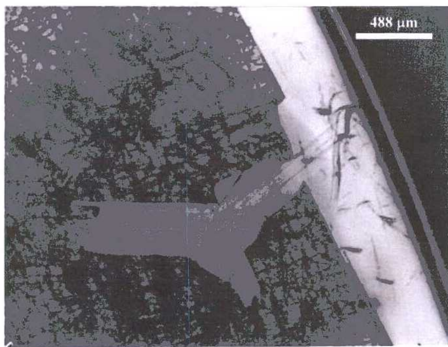
Figura 6.70. Oblea N° 2 del lingote \text{Cd}_{0.96}\text{Zn}_{0.04}\text{Te} , v = 1,66 \text{ mm/h} , revelada con reactivo de Nakagawa.
