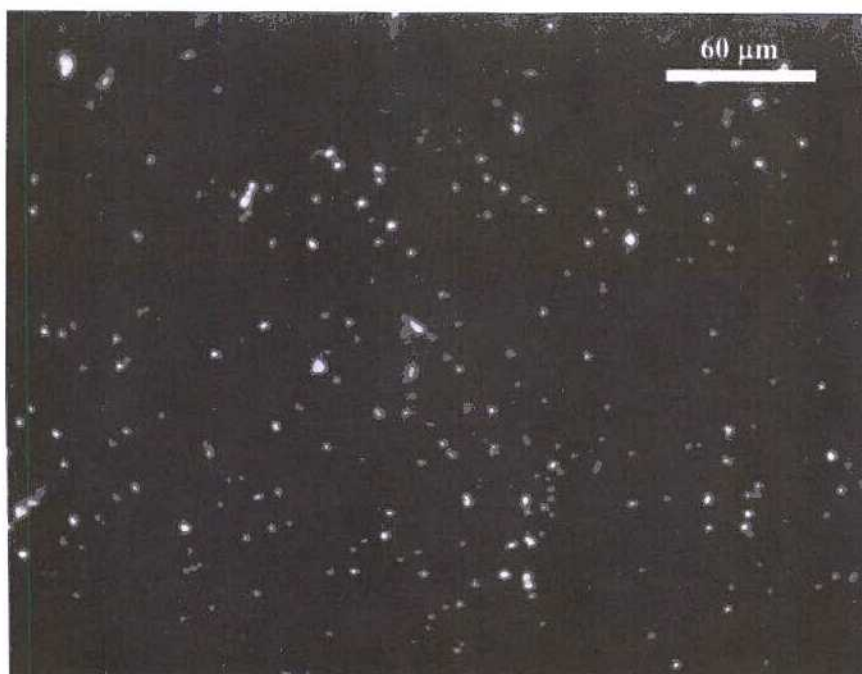
Figura 6.56. \text{Cd}_{0,96}\text{Zn}_{0,04}\text{Te} , v = 1,66 \text{ mm/h} , \delta = 5,7 \text{ E5 cm}^{-2} , \varphi = 33'' (oblea 2, reactivo de Bagai)
