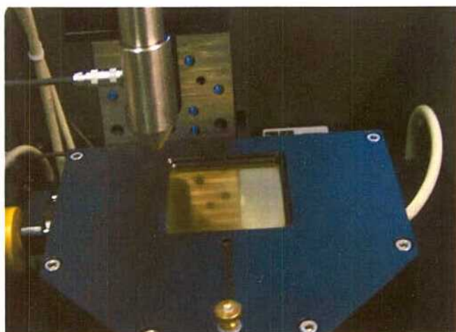
Figura 3.11. Equipo de medida de la resistividad (CoReMa). Fotografía tomada al equipo de la Universidad Autónoma de Madrid.
