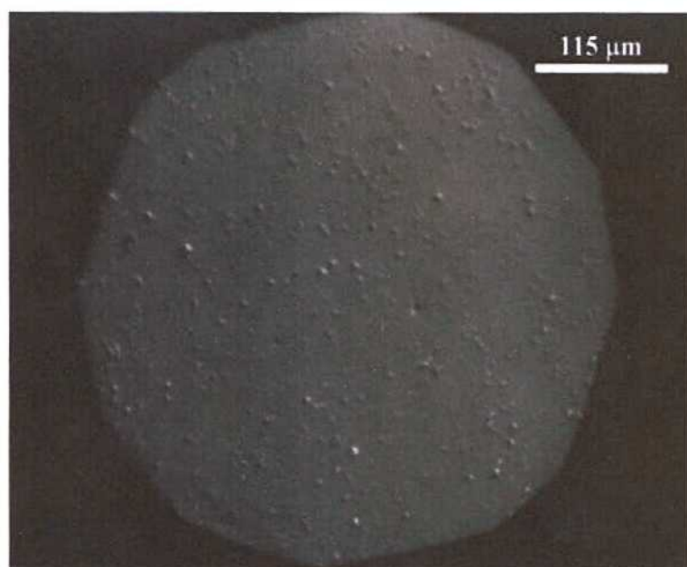
Figura 6.52. CdTe, v = 1,66 \text{ mm/h} , \delta = 6,8 \text{ E5 cm}^{-2} , \phi = 26'' (oblea 5, reactivo de Bagai)
