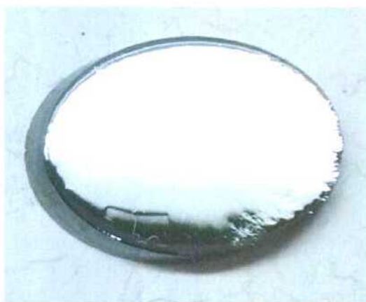
Figura 3.7. Oblea elíptica pulida con \text{Br}_2 – etilenglicol.
