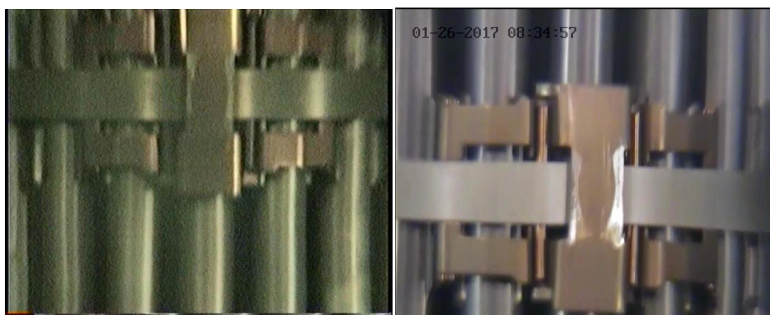
Figuras 32: Imágenes tomadas desde del periscopio del sistema anterior [digitalizada] (izq.) y del nuevo (der.). Vale aclarar que ambas imágenes fueron adquiridas mientras el EC estaba en movimiento.
