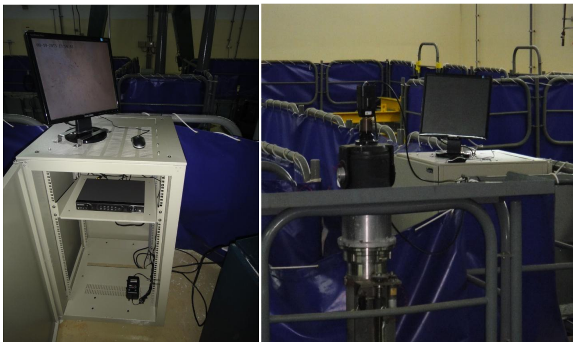
Figura 35: Imagen del sistema de inspección de E.C.s irradiados actualizado montado en su posición en Edificio de piletas 2.
