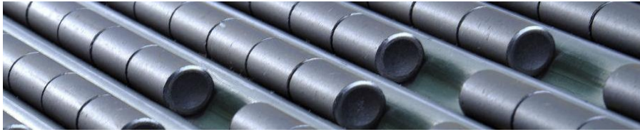
Figura 4: Foto de las pastillas combustibles.
