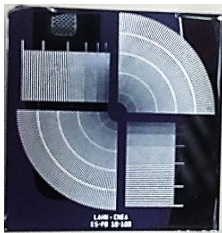
Figura 4.27: Dispositivo de alto contraste neutrónico con recubrimiento de paraloid B-72.
