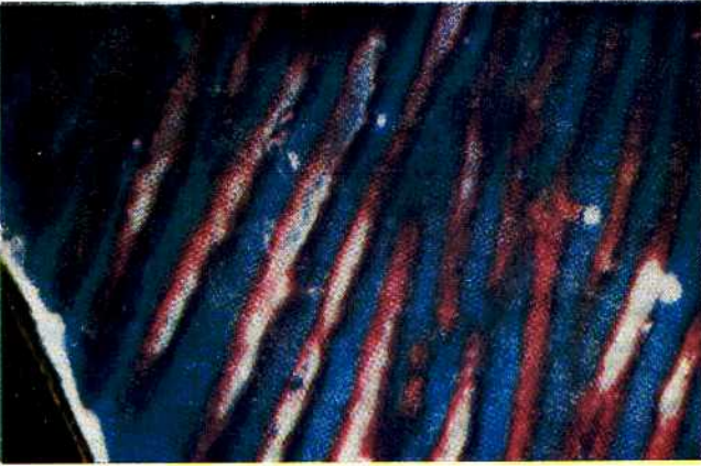
FIG. 9 \times 60 Sous-structure striée rendue visible par les couches d'oxyde.
