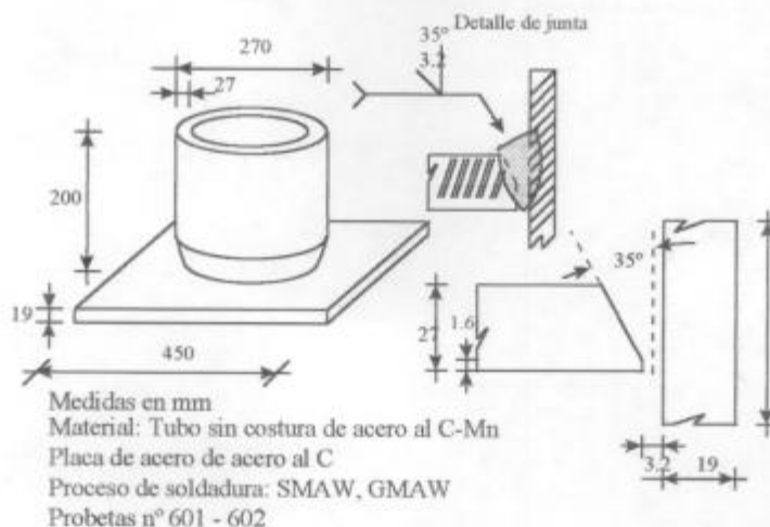
Fig. 3.7 - Probeta tipo tobera. Bisel de 35°
