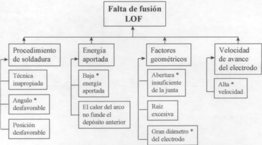
Fig. 1.13 - Causas que originan discontinuidades de tipo LOF.
