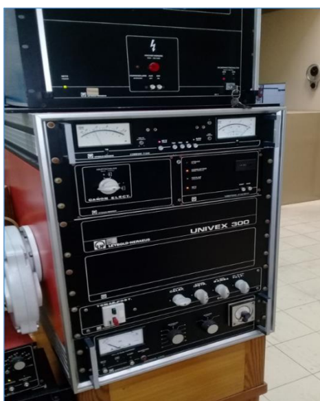
Figura 20. Tablero de control de la evaporadora.
