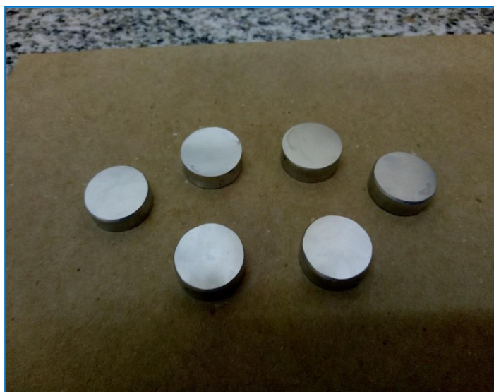
Figura 26. Muestras circulares para la calibración de la microbalanza del equipo de deposición de Ti.
