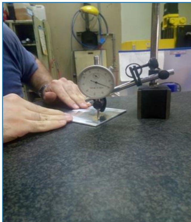
Figura 23. Control de planitud.
