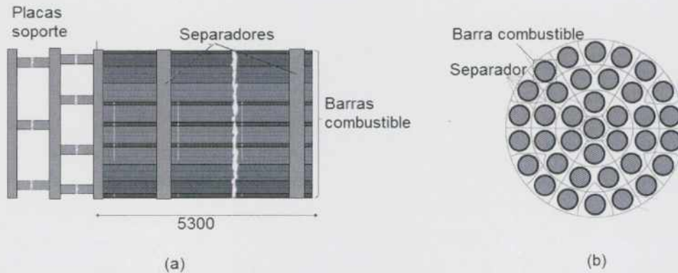
Figura 4.4: Elemento Combustible.(a) Vista longitudinal del elemento combustible (b) corte axial del elemento combustible a la altura de un separador.
