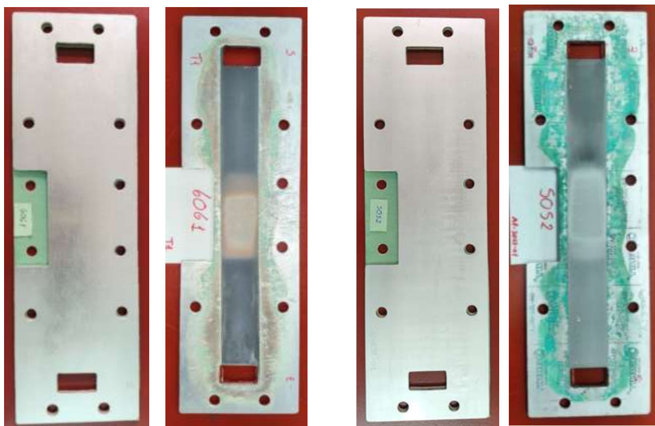
Figura 45: Probetas antes y después del ensayo de corrosión generalizada
