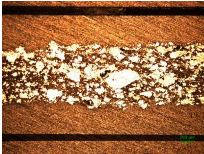
Figura 76: Metalografía de dogboning zona media AA 5052
