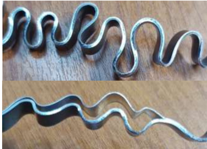
Figura 30: Ensayo de plegado aprobado (arriba) y rechazado (abajo)
