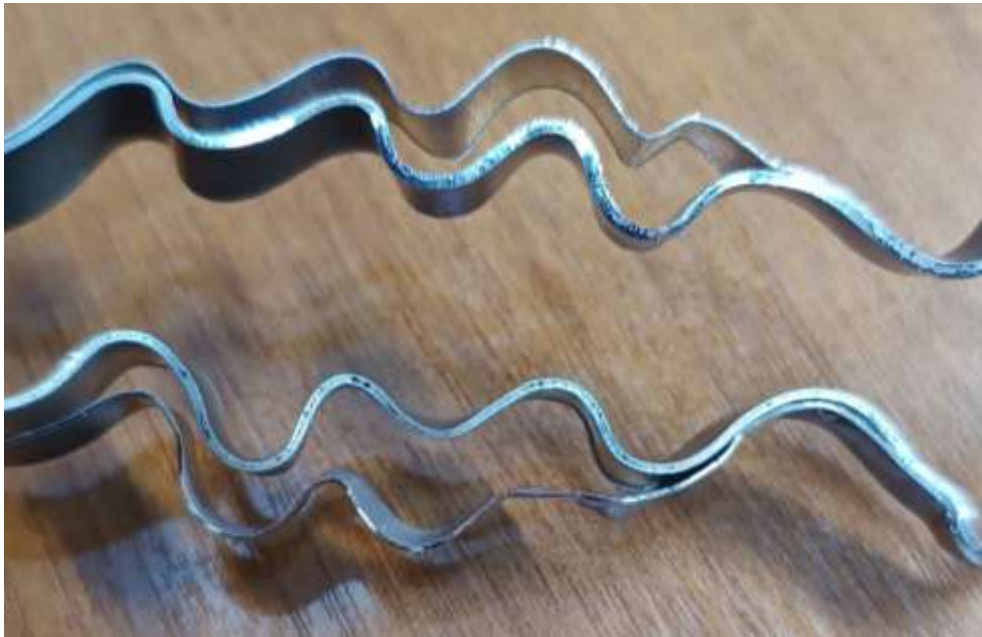
Figura 65: Ensayo de plegado en AA 5052 DEC 1
