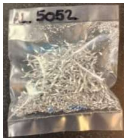
Figura 22: Muestra de viruta para el ensayo de composición química
