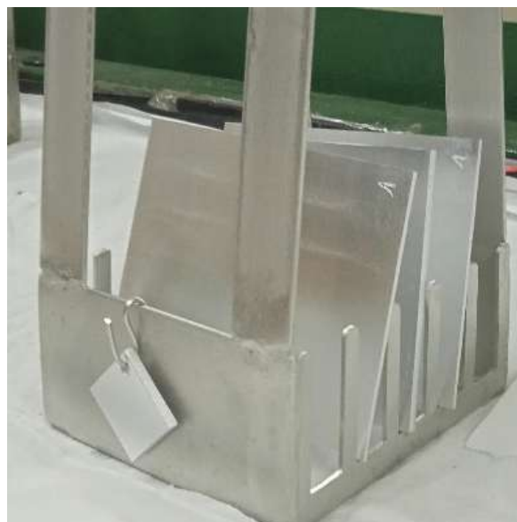
Figura 32: Grupo de tapas, marco y muestra dispuestos para el tratamiento de decapado
