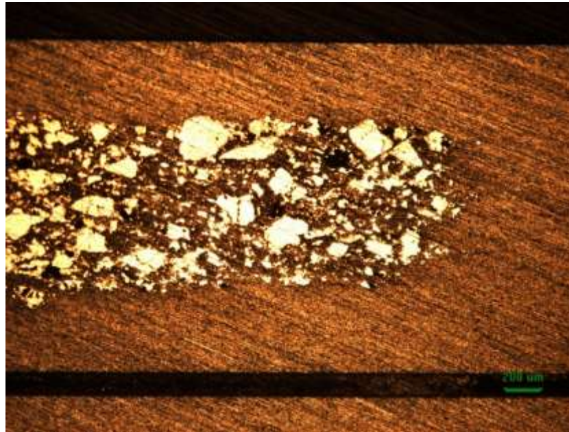
Figura 78: Metalografía de dogboning zona cola AA 5052
