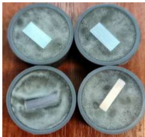
Figura 25: Muestras incluidas para su posterior preparación metalográfica.
