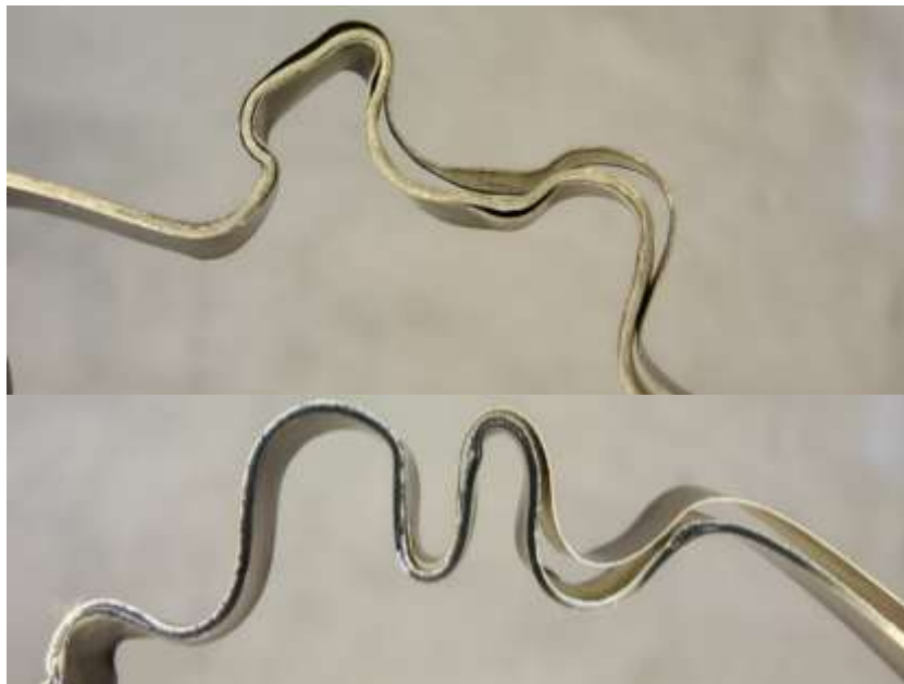
Figura 56: Ensayo de plegado en placa 2
