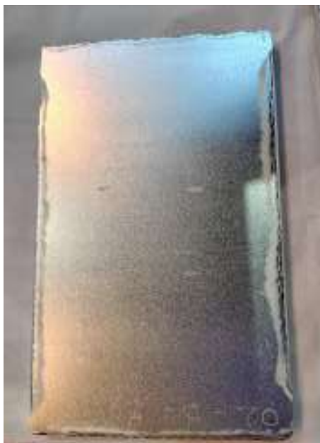
Figura 72: Conjunto soldado con núcleo
