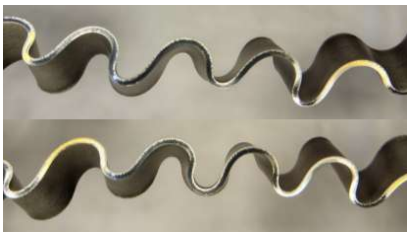
Figura 57: Ensayo de plegado en placa 2 bis
