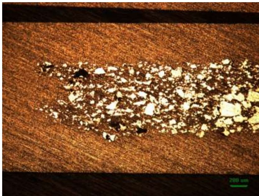
Figura 77: Metalografía de dogboning zona cabeza AA 5052
