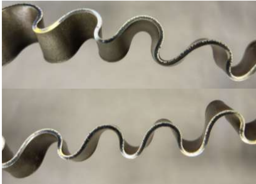
Figura 55: Ensayo de plegado en placa 1
