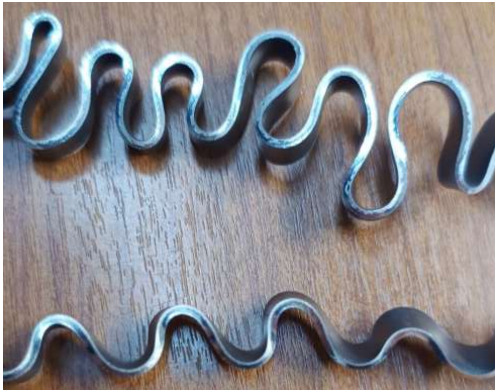
Figura 67: Ensayo de plegado en AA 5052 DEC 3
