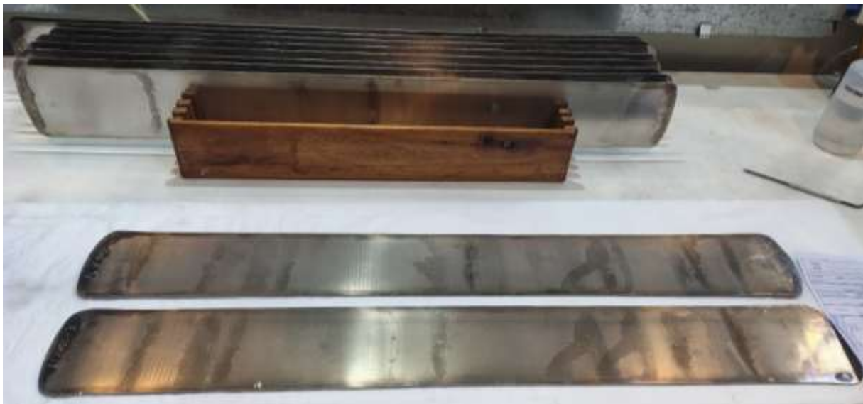
Figura 29: Placas luego de la laminación en caliente
