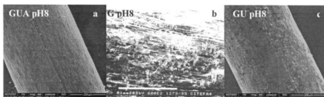
Figura 12- Micrografías obtenidas por MEB de las superficies laterales de las probetas traccionadas hasta la ruptura a pH 8 y al potencial de circuito abierto en las distintas soluciones: a) GUA (la barra blanca indica 200 µm), b) G (la barra blanca indica 100 µm) y c) GU (la barra blanca indica 200 µm).
