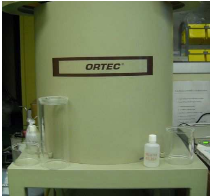
Foto 6.1 – Fuente (recipiente de 100 ml con muestra diluida en agua destilada) y distintos adaptadores para modificar la distancia al detector.
