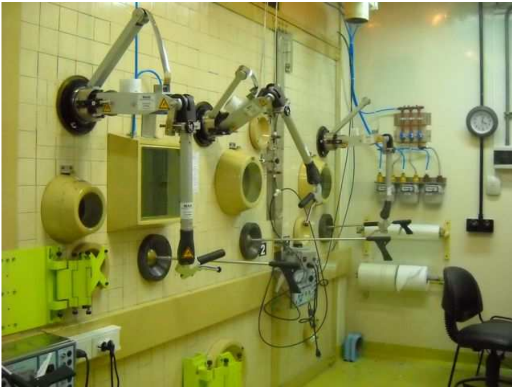
Foto 5.1 – Galería operativa del laboratorio LFR. Se ven allí las celdas radioquímicas con sus telemanipuladores y telepinzas.
