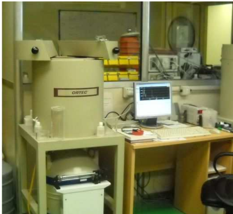
Foto 5.4 – Sala de medición. En la imagen, uno de los detectores de HPGe existentes en ella. En el mismo se efectuaron las mediciones correspondientes al presente trabajo.
