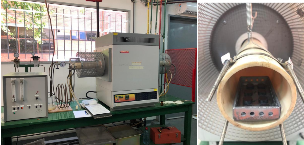
Figura 3.3. A la izquierda, el horno Carbolite usado para realizar los tratamientos térmicos. A la derecha, la nave introduciéndose en la cavidad cilíndrica del horno.
