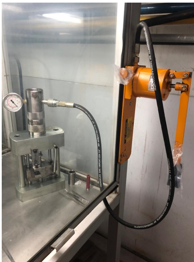
Figura 3.2. Prensa manual de simple efecto usada en el proceso de conformado de pastillas.
