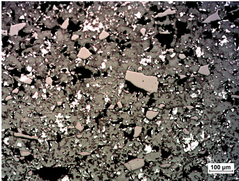
Figura 4.16. Pastilla USiC-7 medida con microscopio óptico a 100x.
