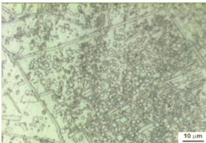
Figura II.15. Imagen de los carburos intragranulares en una muestra de acero inoxidable 310 solubilizado y carburizado 8 horas, tomada con microscópio óptico. Se ve la forma cúbica de algunos precipitados, otros con forma de plaquetas y grupos donde han coalescido.
