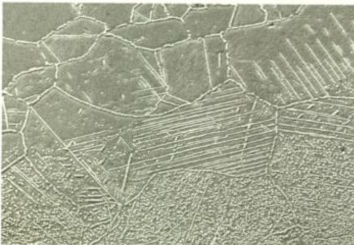
Figura II.18. Vista de la precipitación de los carburos en una región más interna de la misma muestra. Se nota el cambio en la densidad de los carburos precipitados hacia el interior de la probeta. Se destaca una importante concentración de carburos precipitados como plaquetas.
