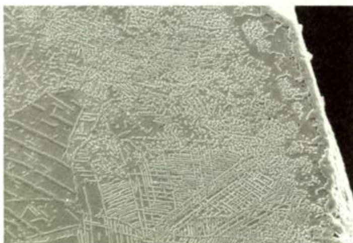
Figura II.6. Otro sector de la misma muestra con gran densidad de carburos. Se observan distribuciones de precipitados con forma de plaquetas con distintas direcciones.
