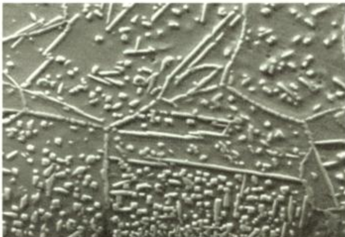
Figura II.14. Aspecto que presentan los carburos intragranulares en la misma muestra. Se ven pequeños carburos con forma cúbica y otros con forma de plaqueta. Se distinguen además, precipitados formados por la coalescencia de varios carburos.
