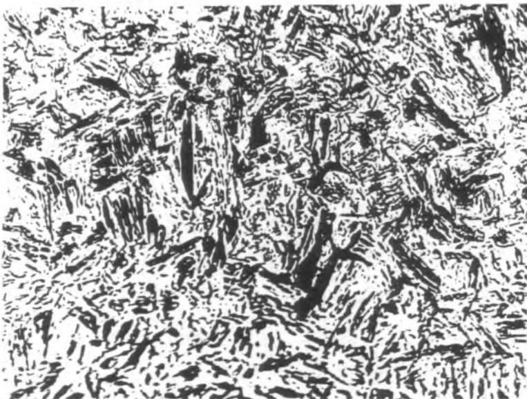
Fotografía No.4.5 Martensita en forma de agujas (probeta 9, Temple). Reactivo de ataque Nital 2, (MO).
