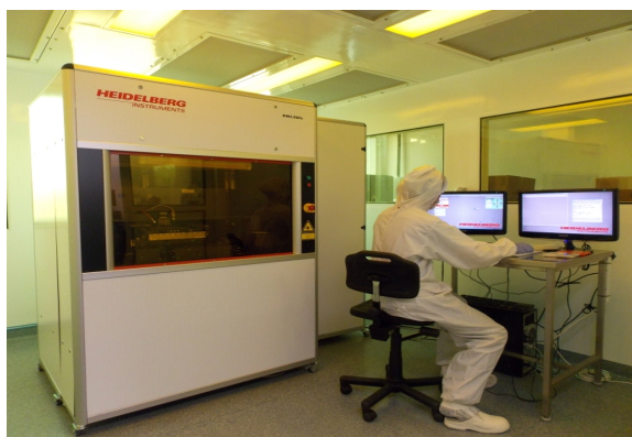
Equipo generador de máscaras. Imprime "plantillas" con áreas opacas y áreas transparentes, con resolución de micrones, para luego usar en litografía.
