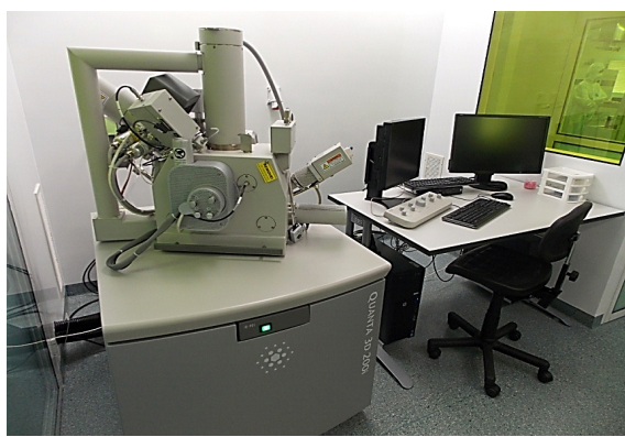
Equipo de haces de iones focalizados que se utiliza para grabar el silicio con resolución de micrones. El vidrio amarillo que se aprecia en la foto ayuda a filtrar las ondas UV, que afectan ciertas resinas usadas en fotolitografía.
