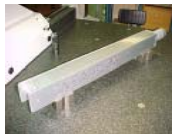
Proyecto CADRIP - Elemento combustible P-07 durante la operación de control final
