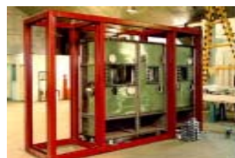
Proyecto LFR Estructura metálica porta blindaje y recintos alfa estancos
