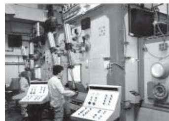
Autoabastecimiento de radioisótopos: Producción de generadores de Molibdeno-99/ Tecnecio 99m – Centro Atómico Ezeiza
