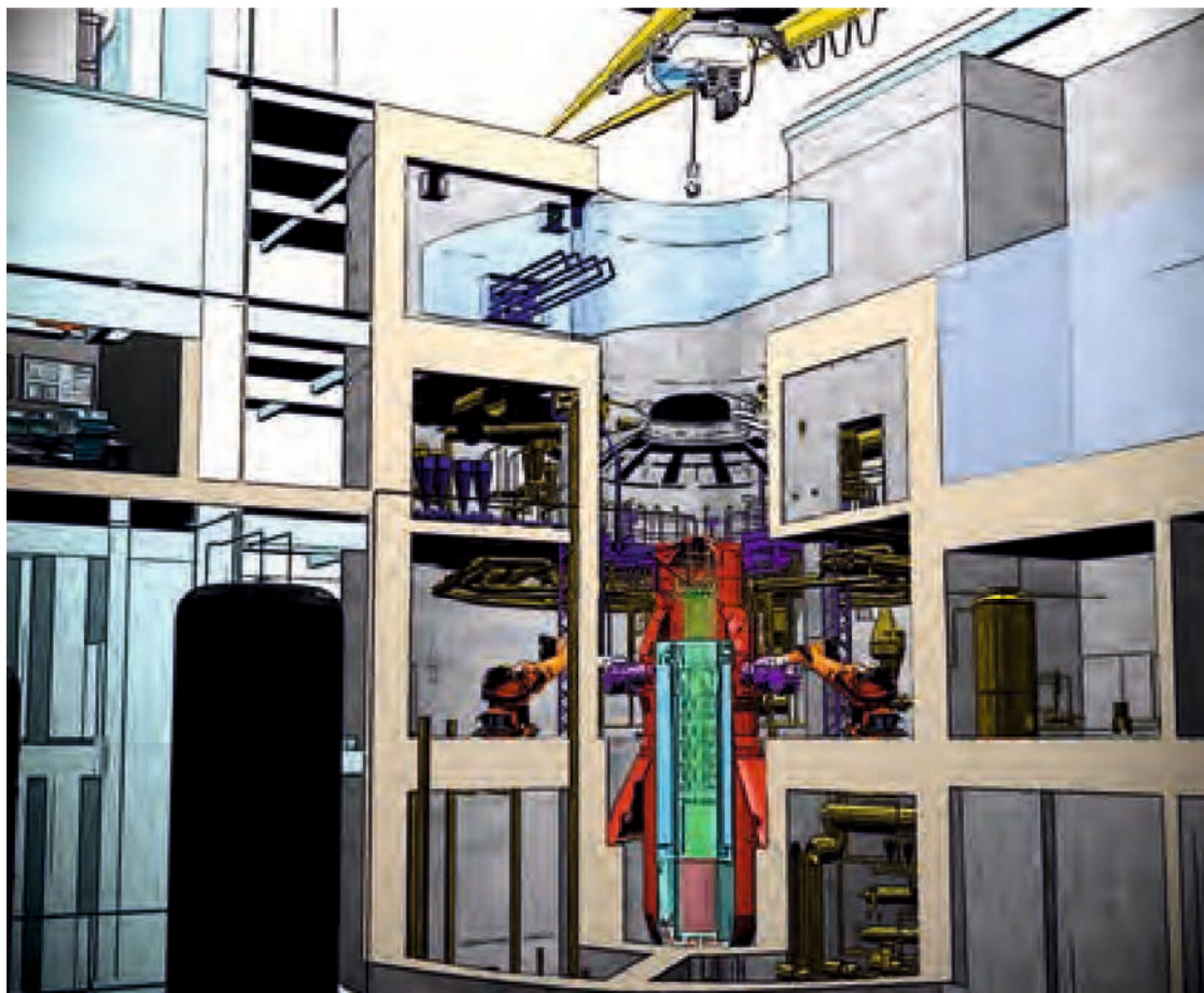
Corte de la Instalación Nuclear
