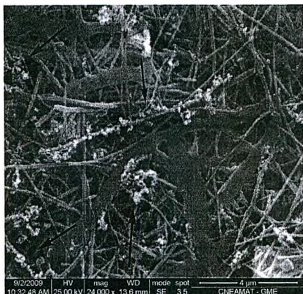
Figura 4.57: Micrografía SEM de los films de CNTs purificados decorados con nanopartículas de \text{Pd}^0 . Se aprecia como las nanopartículas de \text{Pd}^0 se encuentran adheridas a las paredes de los nanotubos (flechas).
