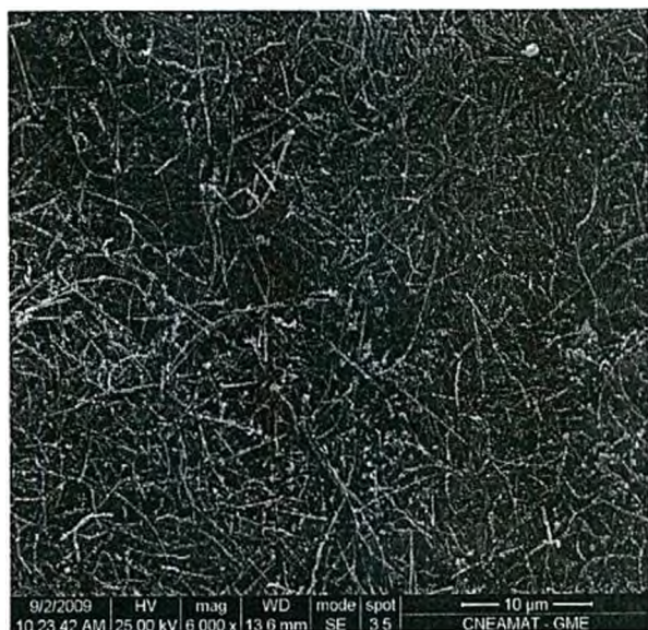
Figura 4.58: Micrografía SEM de la parte posterior del film de CNTs (oxidados en fase gaseosa) decorados con nanopartículas de \text{Pd}^0 . Las mismas se aprecian como puntos distribuidos junto con los nanotubos.
