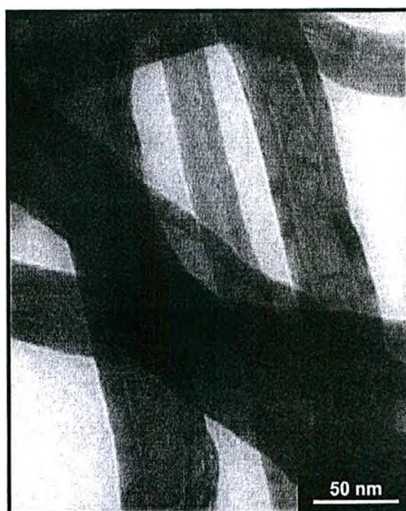
Figura 4.40: Micrografía TEM de los nanotubos individuales que conforman los arreglos auto-alineados sintetizados a partir de CoPc a 895^\circ C . Se aprecian ciertas nanoestructuras de carbono en el interior de los nanotubos.
