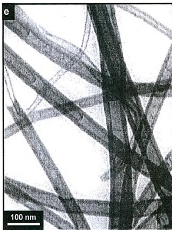
Figura 4.11: (Cont.) Imágenes TEM de los arreglos auto-alineados de CNTs sintetizados a partir de FePc en las condiciones que se detallan en la Tabla 1. (a) CNT-1, (b) CNT-2, (c) CNT-3, (d) CNT-4, y (e) CNT-5.
