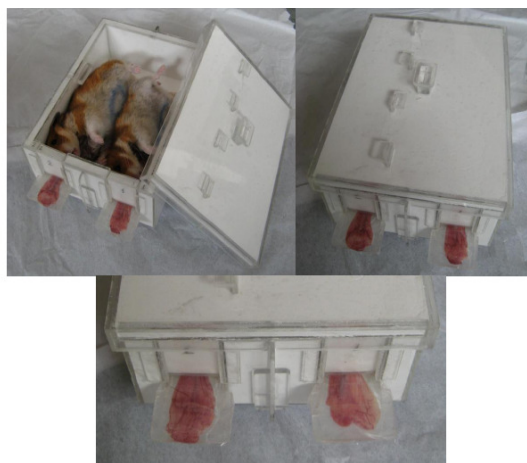
Fig. 18 Vista de la ubicación final de los animales dentro del blindaje (superior izquierda). Superior derecha: blindaje cerrado, listo para ser colocado en la FCCT. Inferior: se puede observar en detalle como quedan posicionadas las bolsas para el tratamiento.
