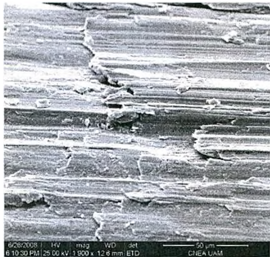
Fig. 6.36. Imagen MEB del corte del fondo del agujero (Escala 50μm)
