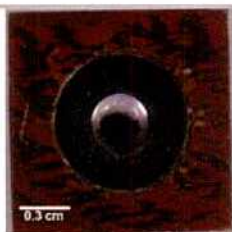
Figura 79. Cara superior de la probeta luego de realizar ensayo de polarización en NaCl 1M + Na 2 SO 4 0,1M pH 6 a 90°C.
