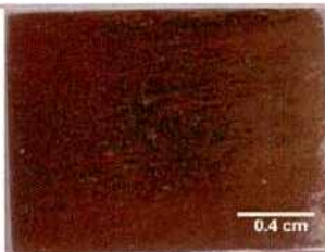
Figura 80. Cara lateral de la probeta luego de realizar ensayo de polarización en NaCl 1M + Na 2 SO 4 0,1M pH 6 a 90°C.
