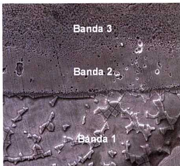
Figura 63. Imagen MEB de la cara superior de la probeta luego de realizar ensayo de polarización en \text{NaCl} 1M + \text{NaNO}_3 0,1M pH 6 a 90^\circ\text{C} donde se identifican 3 zonas de ataque.
