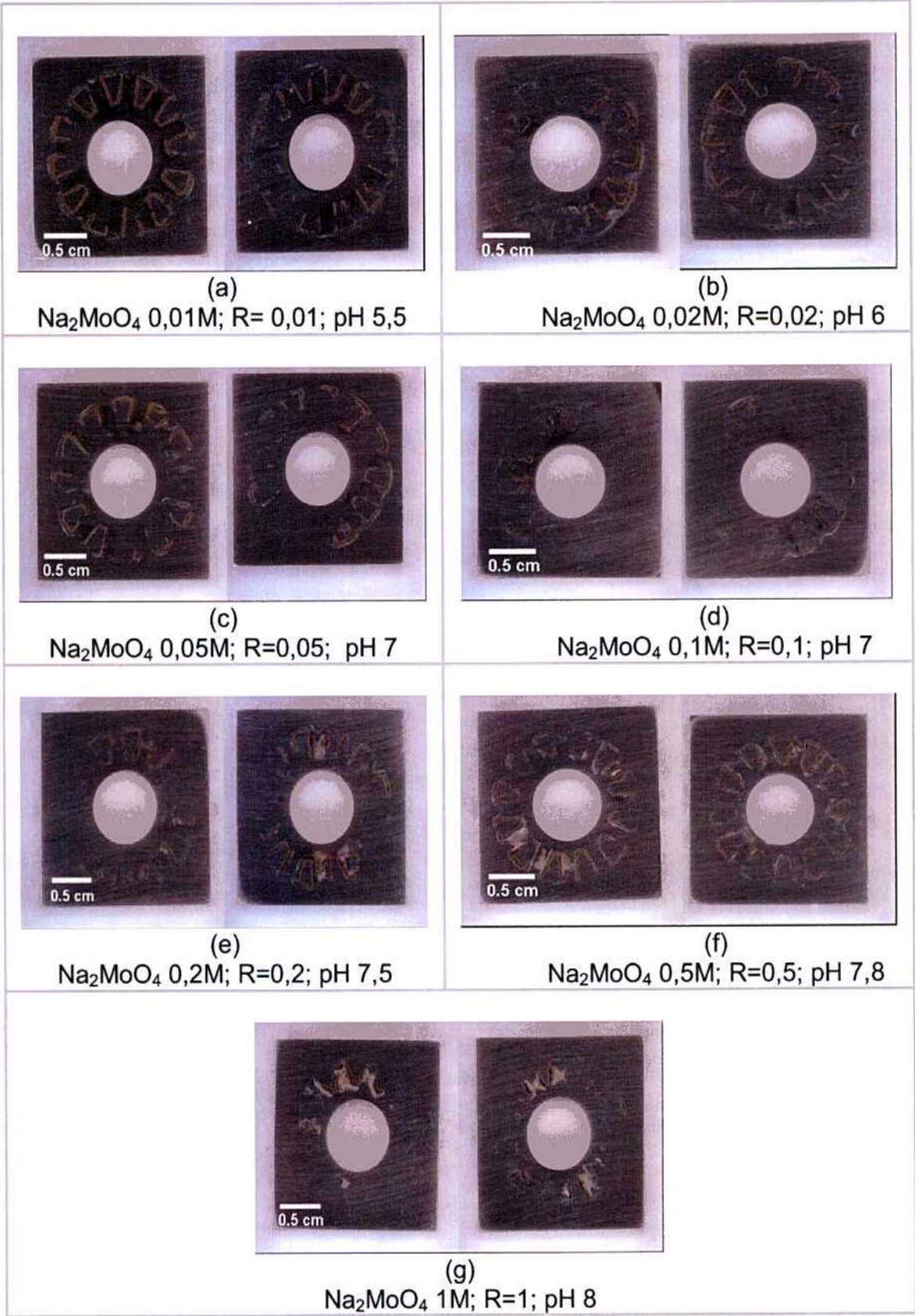
Figura 149. Imágenes de probetas PCA de la aleación 22 después de los ensayos PD-PS-PD en soluciones de cloruro 1M con diferentes concentraciones de \text{Na}_2\text{MoO}_4 desaireadas a 90°C.
