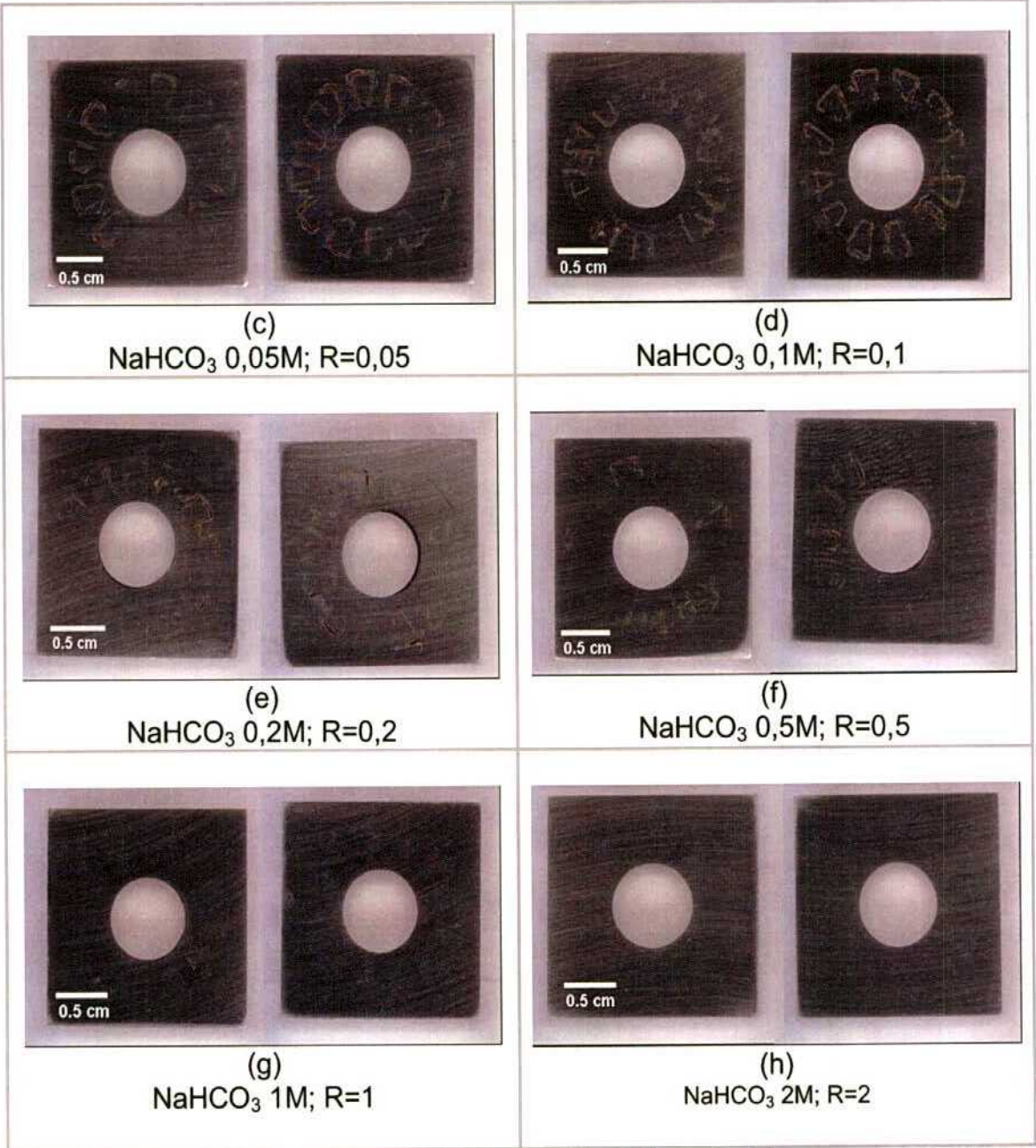
Figura 119. Imágenes de probetas PCA de la aleación 22 después de los ensayos PD-GS-PD en soluciones de cloruro 0,1M con diferentes concentraciones de \text{NaHCO}_3 pH 11,5 desaireadas a 90°C.
