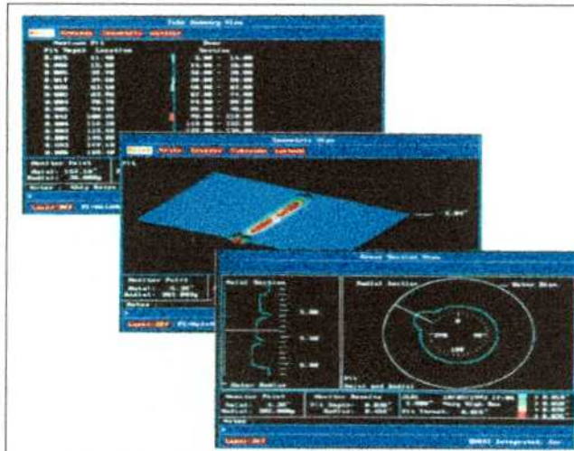
Figura II.7: Vista tridimensional de las paredes internas de un tubo. Se observa un agujero de aproximadamente 1,5 mm de profundidad. [54]
