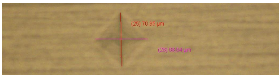
Figura 14: Microscopía muestra compuesta por 30% HA, irradiada con 40 kGy, en presencia de aire. Aumento 20 X
