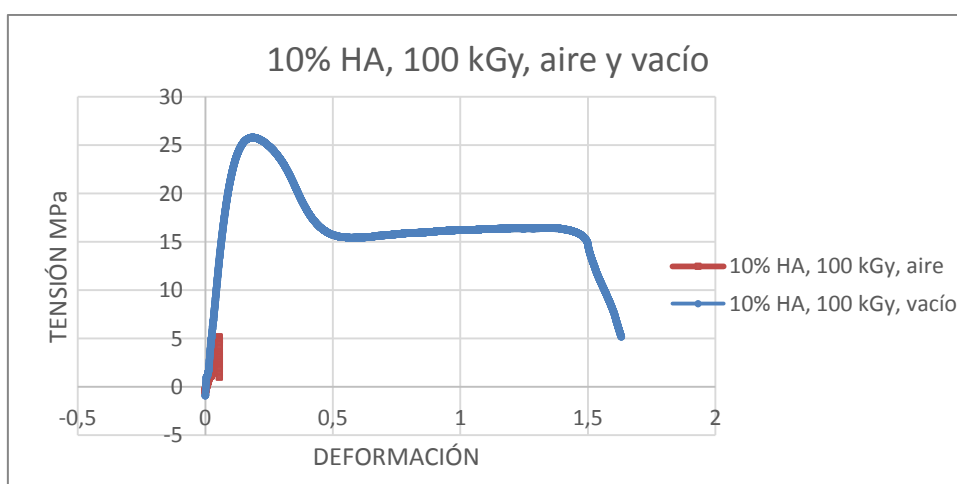
Figura 43: Comparación de muestras compuestas por 10% HA, irradiadas con 100 kGy, envasadas en aire y en vacío
