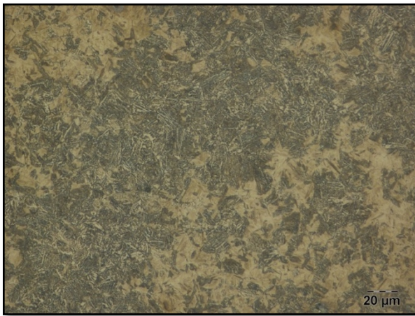
Figura 10: Metalografía de muestra L1-4140-1p-1 en el centro ( r=0 ), templada, 500x
