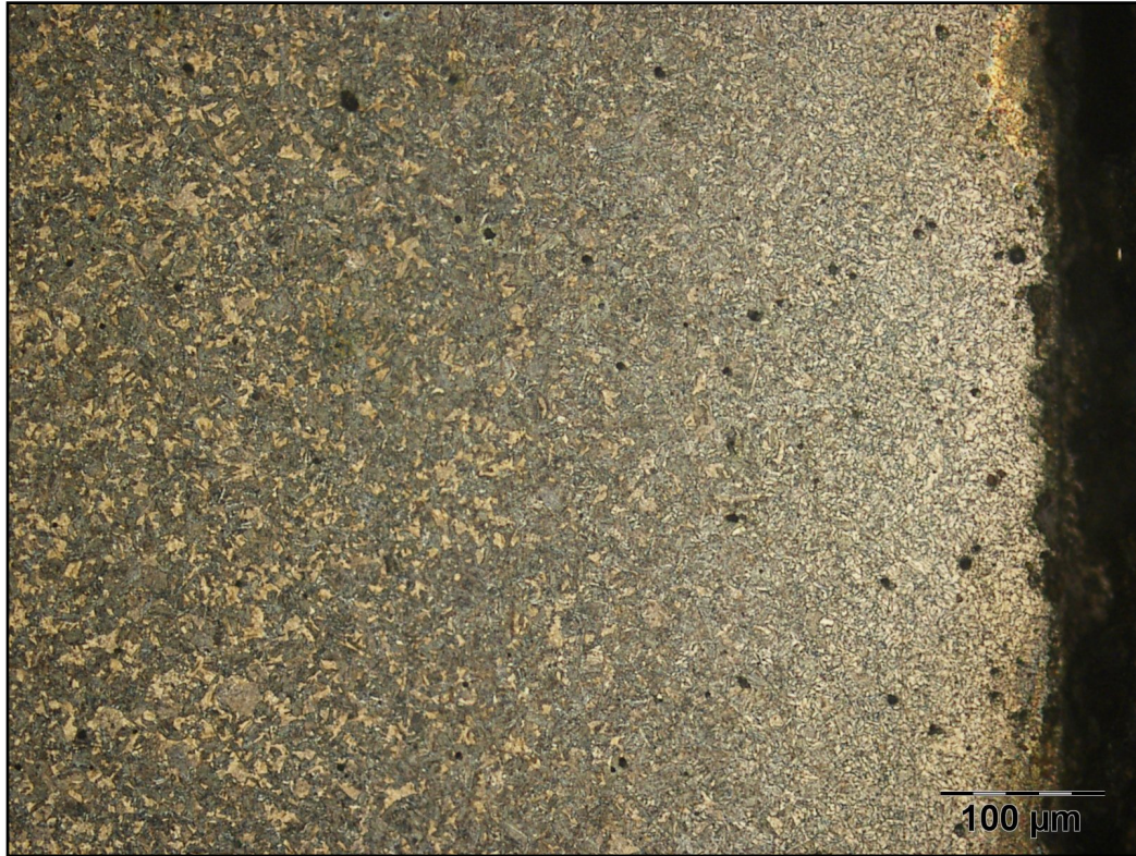
Figura F-3: Superficie (derecha) de la muestra L1-4140-1p-1 (200x)
