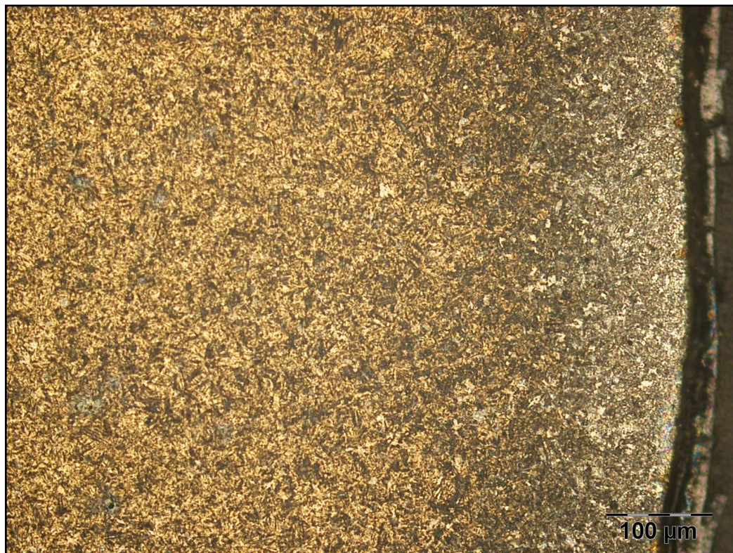
Figura F-4: Superficie (derecha) de la muestra L1-4140-05p-1 (200x)
