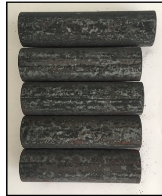
Figura 2: Barras cortadas listas para tratamiento térmico de normalizado Figura 3: Barras normalizadas
