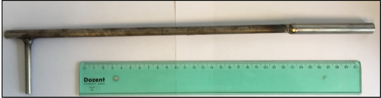
Figura 7: Probeta de ½" de diámetro lista para ser templada
