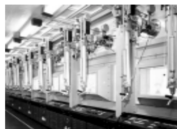
Proyecto LAPEP: Laboratorio de Ensayos Pos Irradiación Galería de celdas blindadas con telemanipuladores - Centro Atómico Ezeiza
