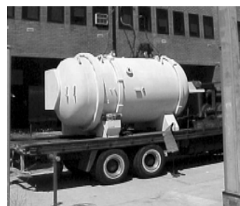
Proyecto Antena radar de apertura sintética: Recepción autoclave para edificio ARAS Centro Atómico Constituyentes
