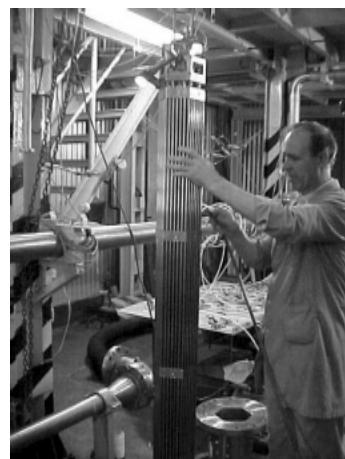
Proyecto CAREM: Prototipo de elemento combustible para el reactor
