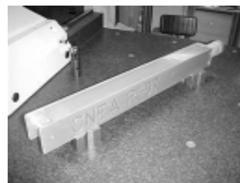
Proyecto CADRIP: Prototipo de elemento combustible P-07 en base a siliciuro de uranio para reactores de investigación durante la operación de control final
