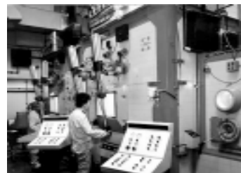
Proyecto Molibdeno 99: Producción de generadores de molibdeno-99/tecnecio 99m Centro Atómico Ezeiza
