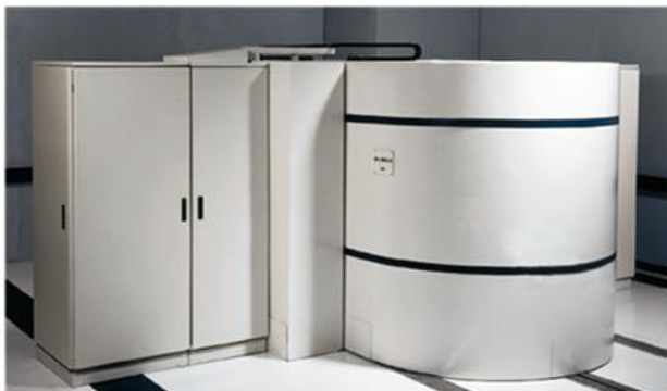
Figura 1. Ciclotrón, con sistema de blindaje acoplado.
