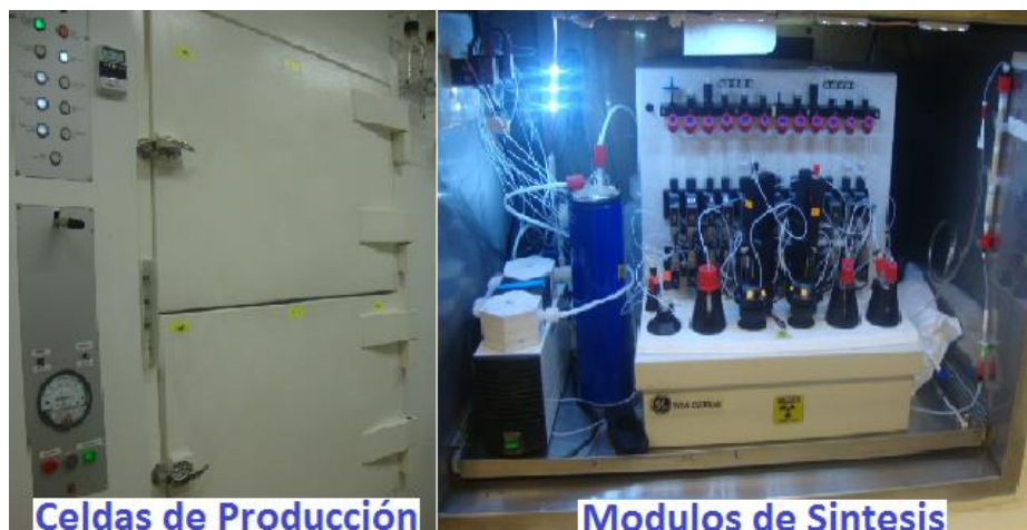
Figura 4. Celdas de producción y módulos de síntesis para producción de FDG.
