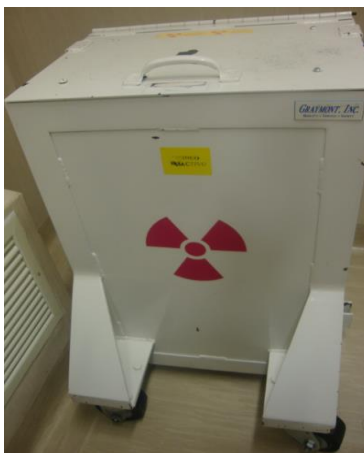
Figura 11. Contenedor utilizado para el almacenamiento temporal de desechos radiactivos en el Laboratorio de Producción, FCDN.
