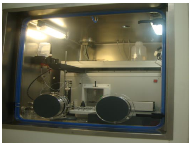
Figura 6. Modulo de dispensado de radiofármacos, FCDN.
