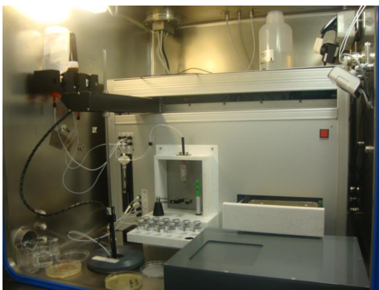
Figura 19. Unidad dispensadora, con autoclave, Laboratorio de Radiofarmacia PET, FCDN.
