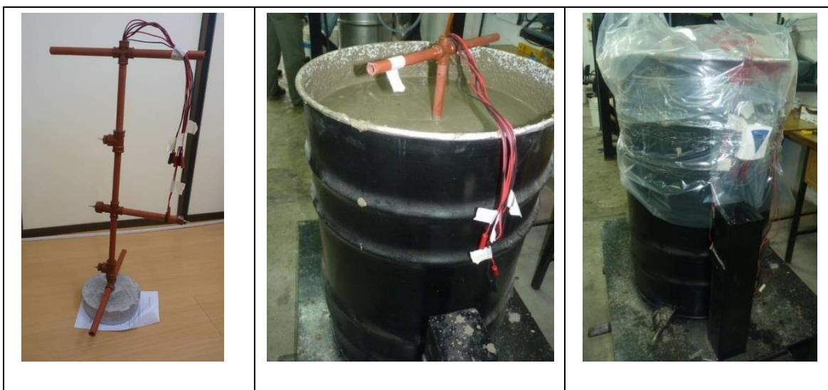
Figura 20: Dispositivo para registrar la temperatura durante el fraguado – Escala 200 litros [21]
