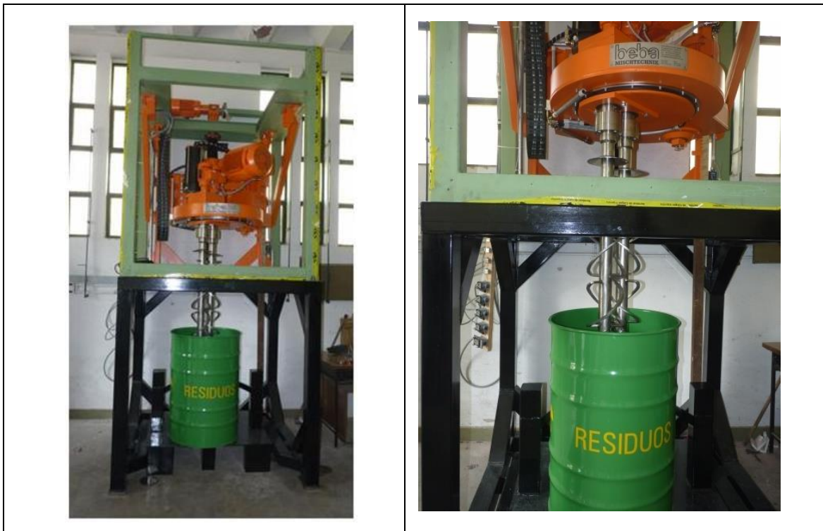
Figura 17: Mezcladoras in drum , escala 200 litros, Beba Mischtechnik
