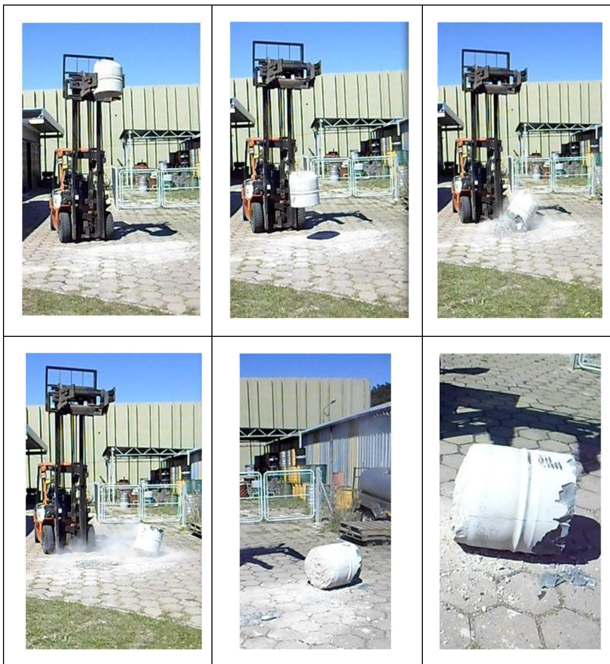
Figura 22: Ensayo de caída de resinas immobilizadas en Cemento Portland
