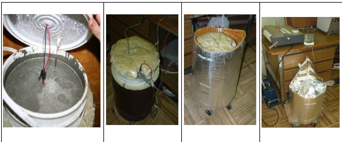
Figura 19: Dispositivo para registrar la temperatura durante el fraguado – Escala 20 litros [21]
