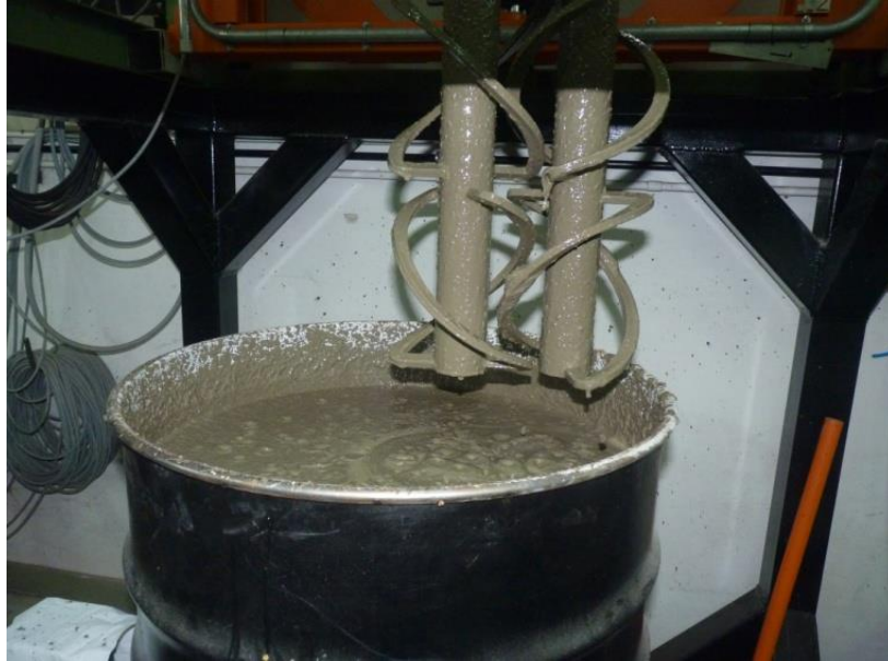
Figura 21: Inmovilización con Cemento Portland de residuos simulados de la PPR, etapa de disolución
