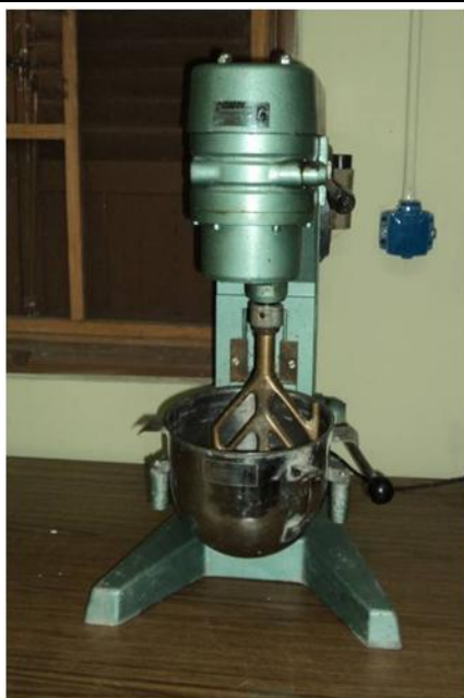
Figura 13: Mezcladora y molde para preparar probetas para ensayo de resistencia a la flexión y compresión, de acuerdo a IRAM 1622
