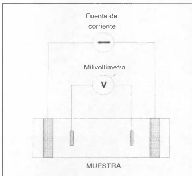
Figura II-7 - Conexiones sobre la muestra para aplicar el método de los cuatro terminales de medición de resistencia eléctrica.
