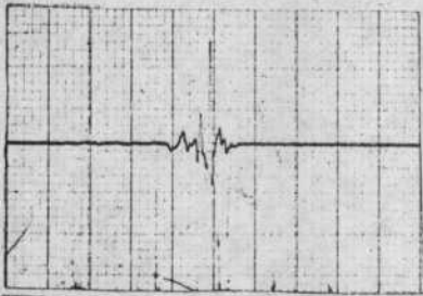
Fig. 10 - Defectos patrones: registros correspondientes a fisuras longitudinales de 120, 72 y 40 de profundidad y 5 mm de longitud.
