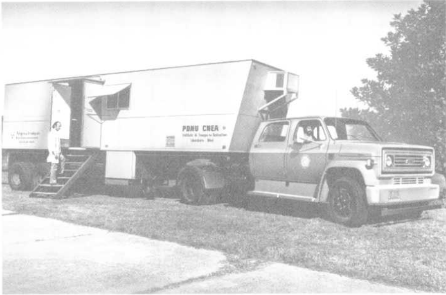
FIG.1. Laboratorio móvil de ensayos no destructivos.
