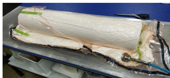
Figura 2.25. Realización de vacío sobre álabe 1.
