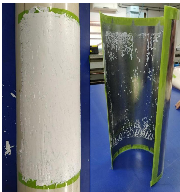
Figura 3.14. Aplicación de top coat con la chapa rolada.
