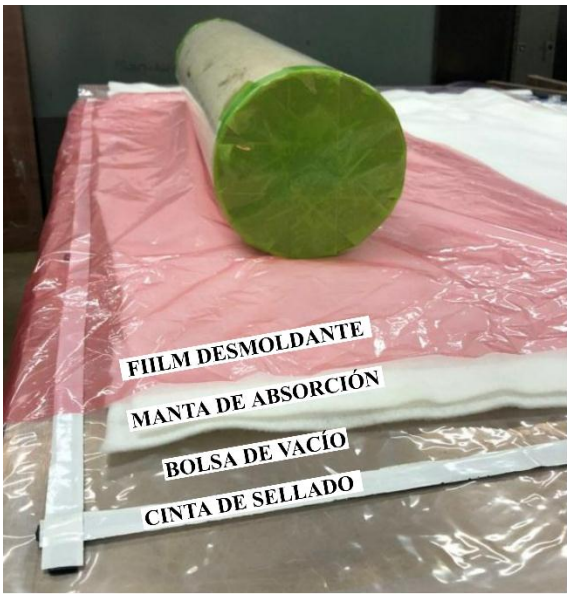
Figura 2.22. Presentación de materiales para la laminación del álabe 1.
