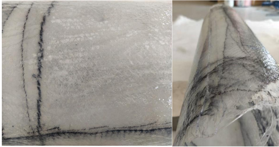
Figura 3.10. Falta de impregnación y arrugas.
