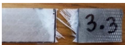
Figura 3.31. Rotura de probetas dentro del tab .
