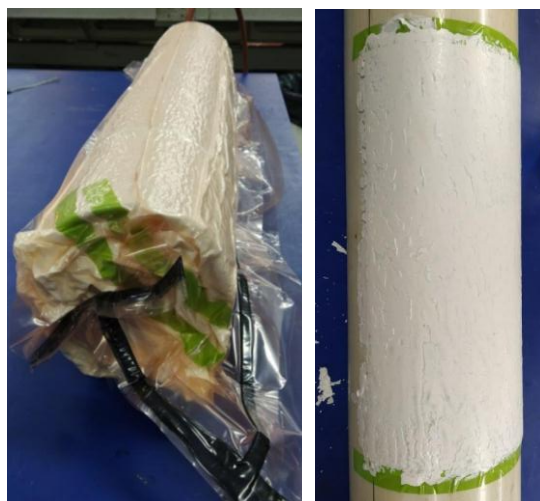
Figura 2.34. Realización de vacío y desmolde.
