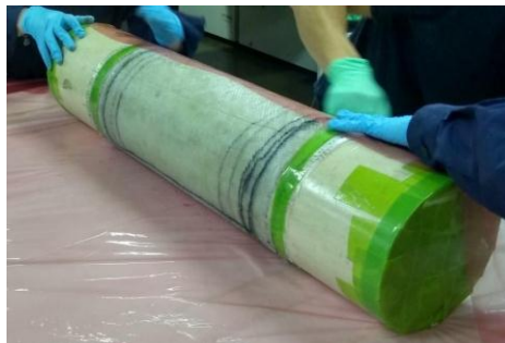
Figura 2.27. Colocación de cinta en bordes en álabe 2.
