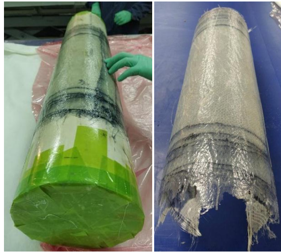
Figura 2.26. Desmolde del álabe 1.
