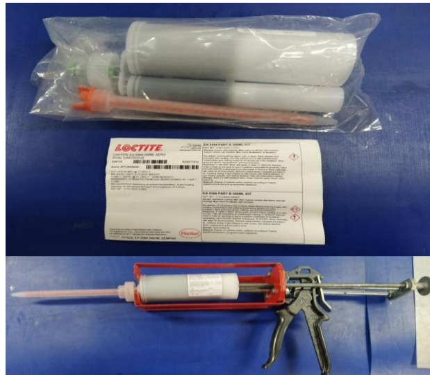
Figura 2.35. Pistola manual de doble cartucho y adhesivo.
