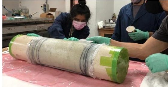
Figura 2.23. Laminación del álabe 1.
