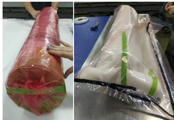
Figura 2.24. Colocación de bolsa de vacío en álabe 1.
