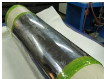
Figura 2.33. Fijado de la chapa a la matriz.
