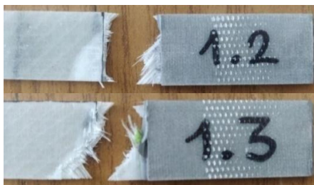
Figura 3.26. Rotura de probetas dentro del tab .
