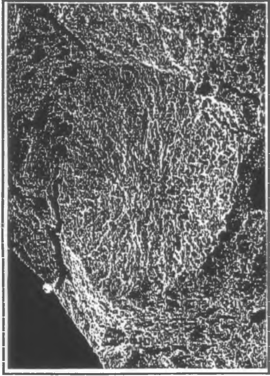
Figura 41b. Otra superficie de fractura que puede haberse iniciado en una inclusión (o tal vez microfisura) También se observa la disposición radial señalada en la figura 41a. Material M670, 200X.
