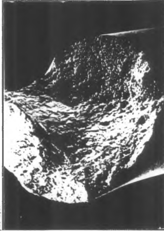
Figura 38a. Material M31, pH=3,5 (25X). La fractura ha sido totalmente frágil. En el plano inferior no hay plasticidad. Notar que este daño se produce para una velocidad de deformación seis veces mayor que la sugerida por E.F.C. ( 6,4 \times 10^{-6} \text{ seg}^{-1} ).
