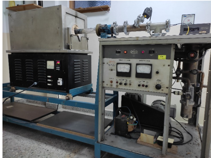
Figura 3.2: Horno y equipo de vacío utilizados para la realización de los tratamientos térmicos.
