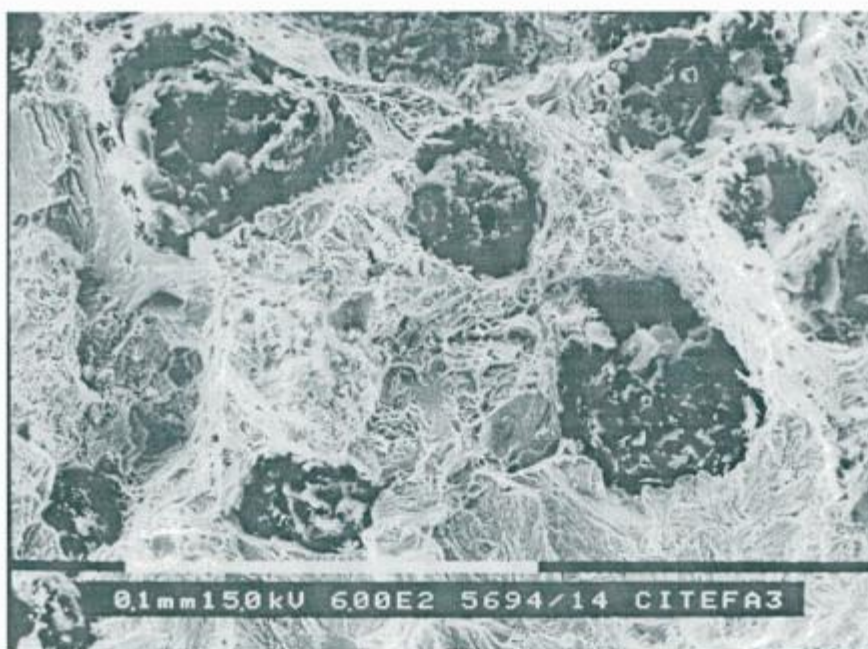
Figura 52: Superficie de fractura de una muestra ADI 1S a +20°C. Se observan zonas de microhuecos alrededor de los nódulos y zonas de cuasiclivaje.
