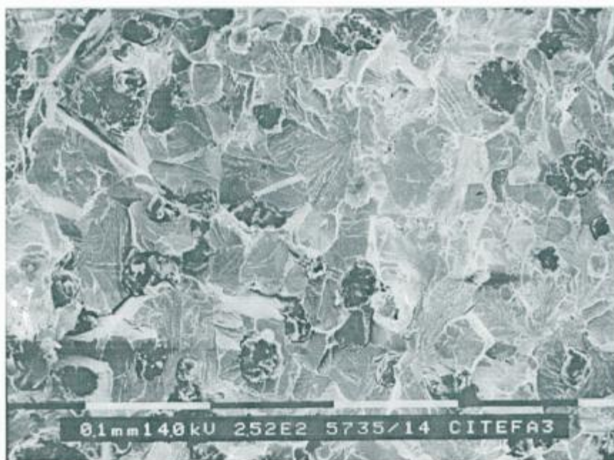
Figura 49: Superficie de fractura de una muestra ACS a -60°C. Se observa una fractura frágil por clivaje, hay baja cantidad de nódulos atravesados y aparecen fisuras secundarias en la superficie.
