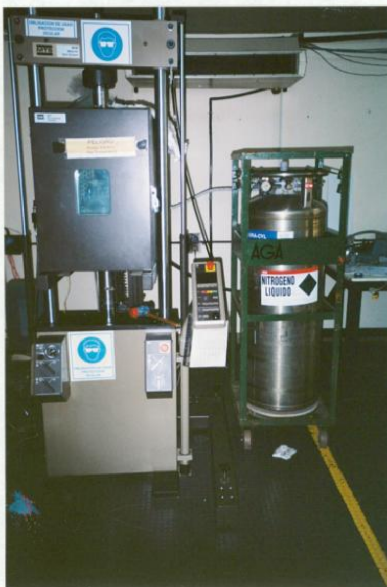
Figura 20a: Vista del conjunto. Máquina de ensayos MTS 810 con cámara ambiental MTS 651 y tanque de nitrógeno líquido.
