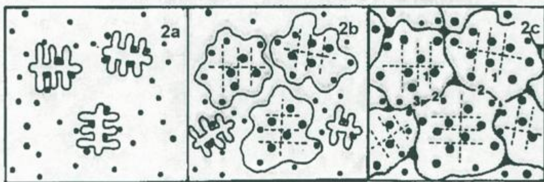
Figura 2: Esquema de la secuencia de solidificación de una fundición FE; 2a: nucleación de la austenita y contacto con los esferoides, 2b: encapsulado de los esferoides, 2c: crecimiento, redondeo y contacto de las células [1: cuerpo de celda, 2: borde de celda, 3: última zona en solidificar (LTF last to freeze)]. Ref: 3.
