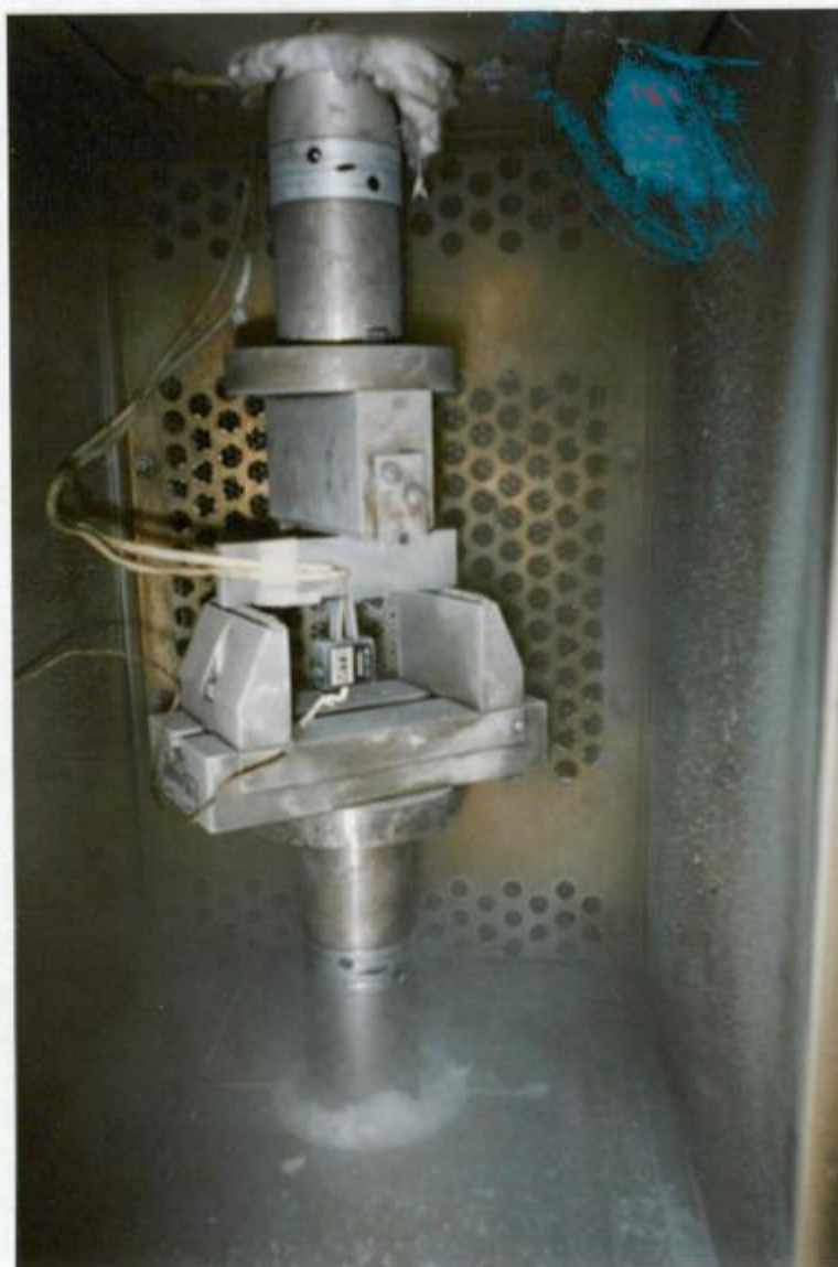
Figura 20 b: Detalle del dispositivo de flexión en el interior de la cámara ambiental. Nótese el extensómetro y la termocupla (vaina blanca) adosados a la probeta.
