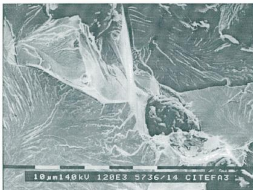
Figura 50: Detalle de la figura anterior mostrando la ausencia de microhuecos en el contorno del nódulo.
