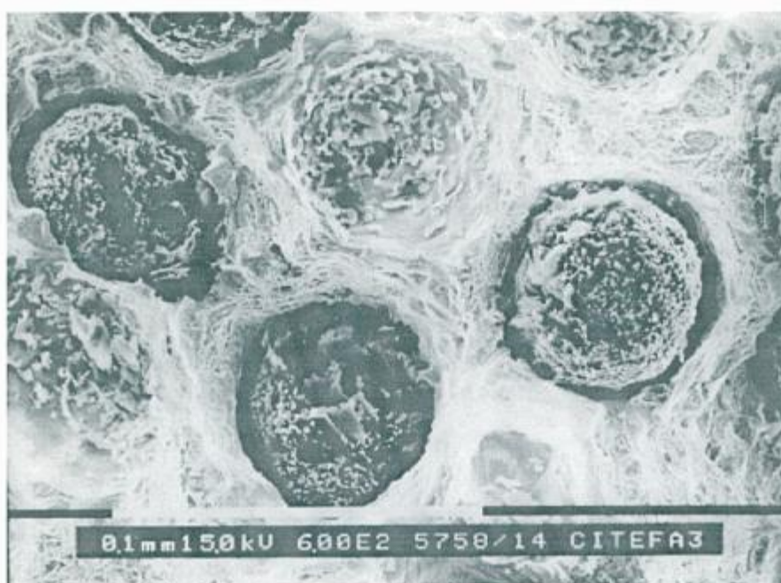
Figura 59: Superficie de fractura de una muestra ADI 4B a +20°C. Decohesión de los nódulos y microhuecos en la zona internodular.
