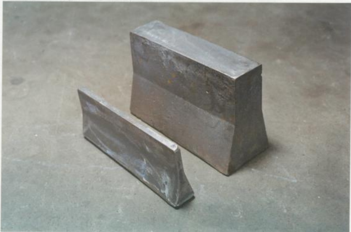
Figura 17: Fotografía de los bloques “Y” de 13 y 75 mm de espesor.
