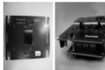
Fotomultiplicador de Silicio para AMIGA (izq); Electrónica frontal de los detectores de AMIGA (der)
