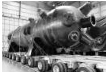
Central Nuclear Embalse – Extensión de vida – Nuevo generador de vapor
