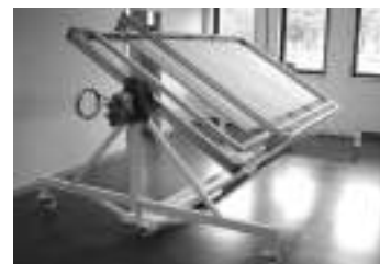
Proyecto Paneles solares Soporte giratorio con sistema de posicionamiento 3-D para la integración de módulos Centro Atómico Constituyentes
